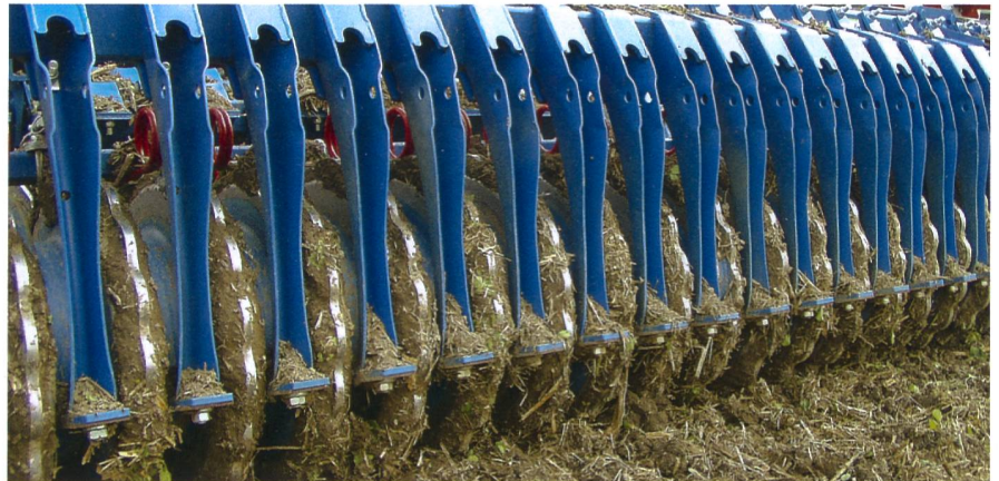
Ein Nachläufer ist zwingend, nasse Einsatzbedingungen aber schaffen immer Probleme.
