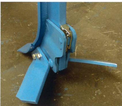
Schnellwechselsysteme reduzieren den Zeitaufwand beim Scharwechsel erheblich.
