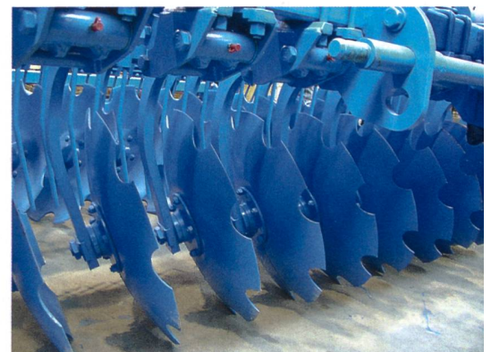
Ein guter Untergriff und grob gezackte Scheiben sichern eine hohe Aggressivität.
