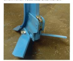
Schnellwechselsysteme reduzieren den Zeitaufwand beim Scharwechsel erheblich.
