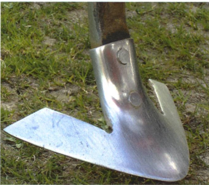
Gänsefusssschare eignen sich vorzüglich für die flache Stoppelbearbeitung. Sie sind aber einem hohen Verschleiss unterworfen.
