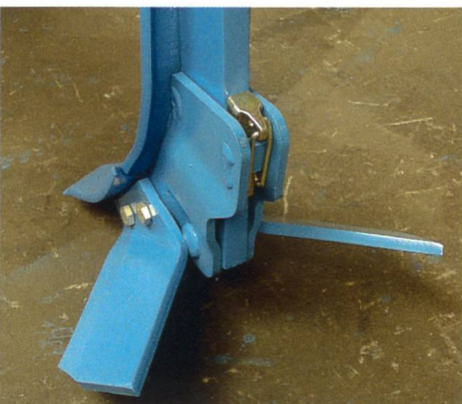
Schnellwechselsysteme reduzieren den Zeitaufwand beim Scharwechsel erheblich.
