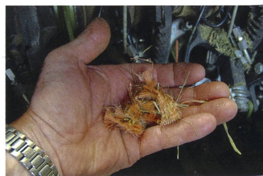
Typisches Merkmal des Deering-Knoters sind die kleinen Garnreste auf der Balle.
