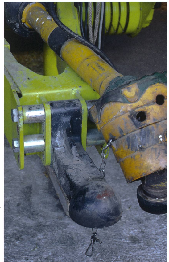
Kugelkopf-Anhängevorrichtungen reduzieren den Verschleiss bei Quaderballenpressen ganz erheblich.
