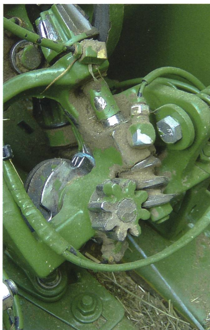
Einfachknoter, System Deering, wie er von John Deere auf Hartballenpressen eingebaut wurde.
