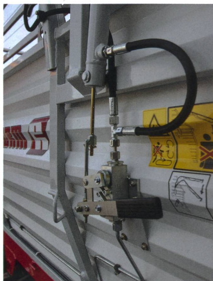
Einstellbare Begrenzung des Öffnungswinkels des hydraulisch angehobenen Hecktors.
