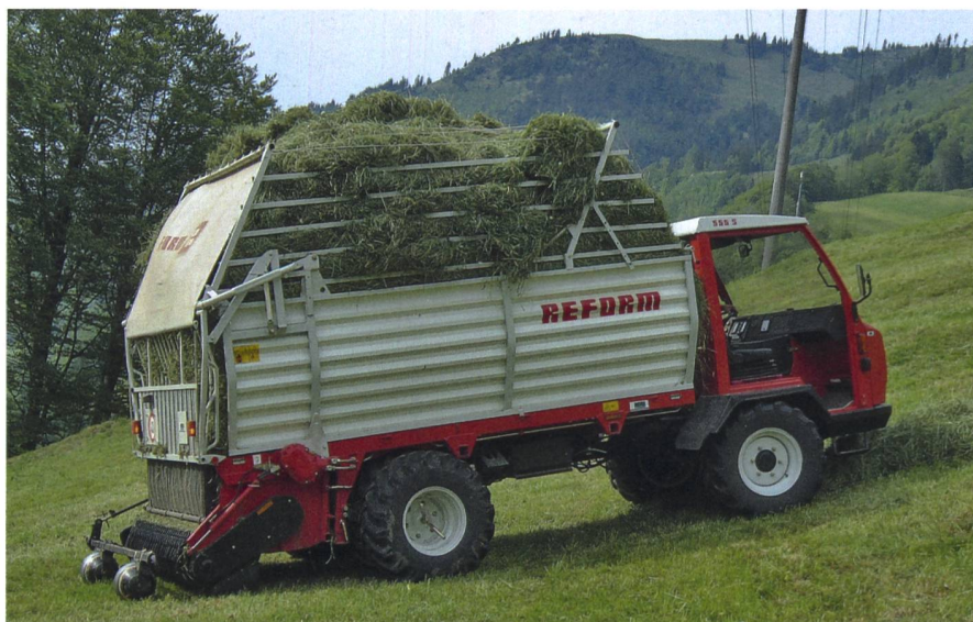
Beste Boden Anpassung über die Parallelsteuerung der Tasträder. Diese lassen sich in der Höhe werkzeuglos verstellen. (Bilder: Ueli Zweifel)
