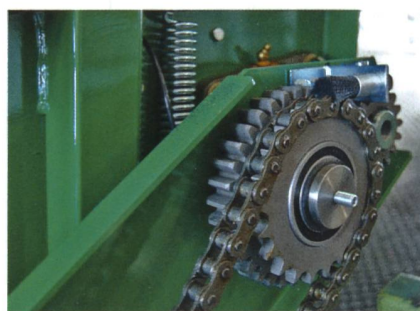
Automatische Schmierung des Förderantriebs mit einem Ölstreicher.
