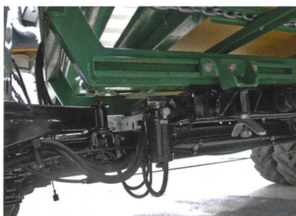
Lüönd-Ladewagenaufbauten lassen sich über geschraubte Anbauteile auf jedem Transportermodell anpassen.
