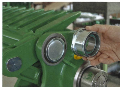
Wartungsfreie Lagerung der Pickup-Förderschwingen am Lüönd-Ladegerät.
