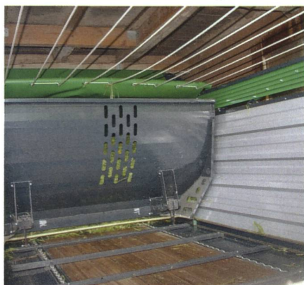
Schiltrac-Sonderausstattung: Kratzbodenschubwand für die rasche und vollständige Entleerung.
