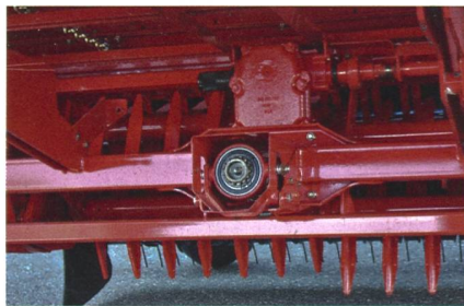
Schnellkupplungssystem: Werkzeuglos und ohne Gelenkwelle lässt sich das Arbeitsgerät auf- und abbauen.
