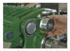
Wartungsfreie Lagerung der Pickup-Förderschwingen am Lüönd-Ladegerät.
