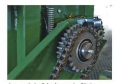
Automatische Schmierung des Förderantriebs mit einem Ölstreicher.
