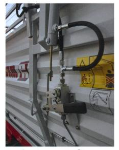
Einstellbare Begrenzung des Öffnungswinkels des hydraulisch angehobenen Hecktors.
