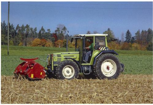
Maisstrohhäckseln mit unterschiedlichen Schlägeln – Versuch mit dem Kuhn Mulcher BPR 280 (Foto: Joachim Sauter, ART).
