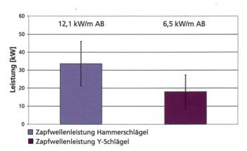
Abb. 4: Zapfwellenleistung mit Standardabweichung der unterschiedlichen Schlägelformen bei Frontanbau in Maisstroh.
