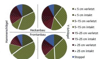
Abb. 6: Häcksellängenverteilung von Maisstroh bei unterschiedlichen Schlägelformen bei Front- und Heckanbau; noch verbleibende, verwurzelte Stoppeln wurden ebenerdig abgeschnitten.
