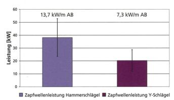
Abb. 5: Zapfwellenleistung mit Standardabweichung der unterschiedlichen Schlägelformen bei Frontanbau in Wiesenaufwuchs.
