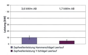
Abb. 2: Benötigte Zapfwellenleistung mit Standardabweichung der unterschiedlichen Schlägelformen im Leerlauf.
