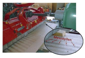
Abb. 7: Messeinrichtung: austauschbare Leisten mit insgesamt sieben Messstellen vor, unter und hinter dem Rotor ermöglichen, die Druckverhältnisse unter jedem Schlägel einzeln zu erfassen (Foto: Roy Latsch, ART).
