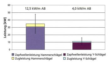
Abb. 3: Gesamtleistungsbedarf mit Standardabweichung der unterschiedlichen Schlägelformen bei Heckanbau in Maisstroh.
