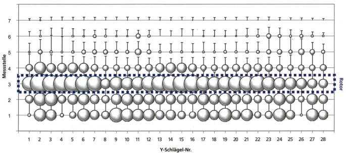
Abb. 9: Schematische Sicht von oben: Druckverteilung unter dem Rotor bei Einsatz von **Y-Schlägeln**; Kreisdurchmesser entspricht Mittelwert [mbar] mit Standardabweichung (Messstellen 1 und 5 liegen je 20 cm vor und hinter dem Rotor).
