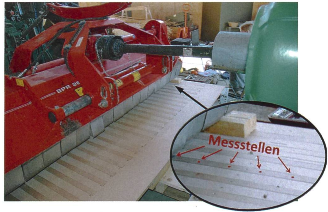
Abb. 7: Messeinrichtung: austauschbare Leisten mit insgesamt sieben Messstellen vor, unter und hinter dem Rotor ermöglichen, die Druckverhältnisse unter jedem Schlägel einzeln zu erfassen (Foto: Roy Latsch, ART).
