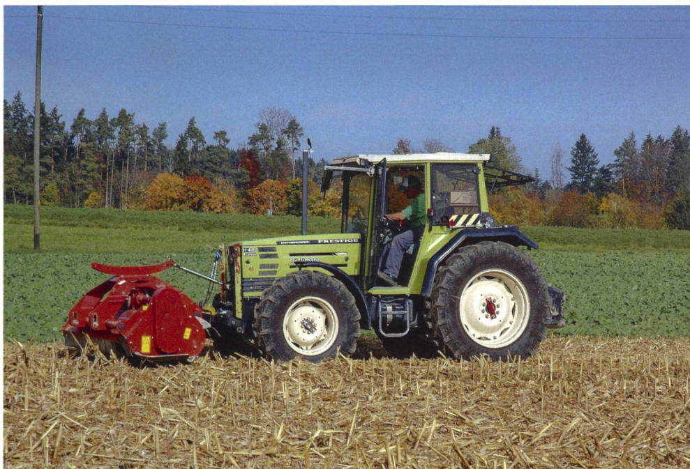
Maisstrohhäckseln mit unterschiedlichen Schlägeln – Versuch mit dem Kuhn Mulcher BPR 280 (Foto: Joachim Sauter, ART).
