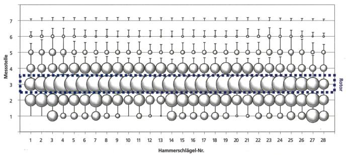
Abb. 8: Schematische Sicht von oben: Druckverteilung unter dem Rotor bei Einsatz von Hammerschlägeln; Kreisdurchmesser entspricht Mittelwert [mbar] mit Standardabweichung (Messtellen 1 und 5 liegen je 20 cm vor und hinter dem Rotor).
