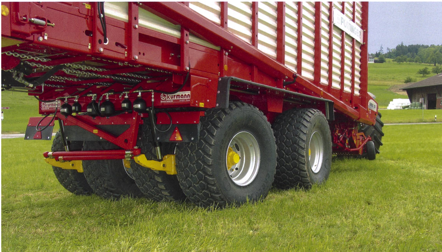
Das 8-Rad-Fahrwerk von Kurmann AG – Inbegriff für höchste Ansprüche, als Ausrüster grossdimensionierter Lade- und Erntewagen. (Bilder: zVg)
