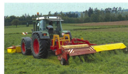
Zwei typische Kurmann-Entwicklungen: Ankopplung des Mähaufläuchers über den Hydro-Lift, ohne das Heckmähdwerk zu belasten.
