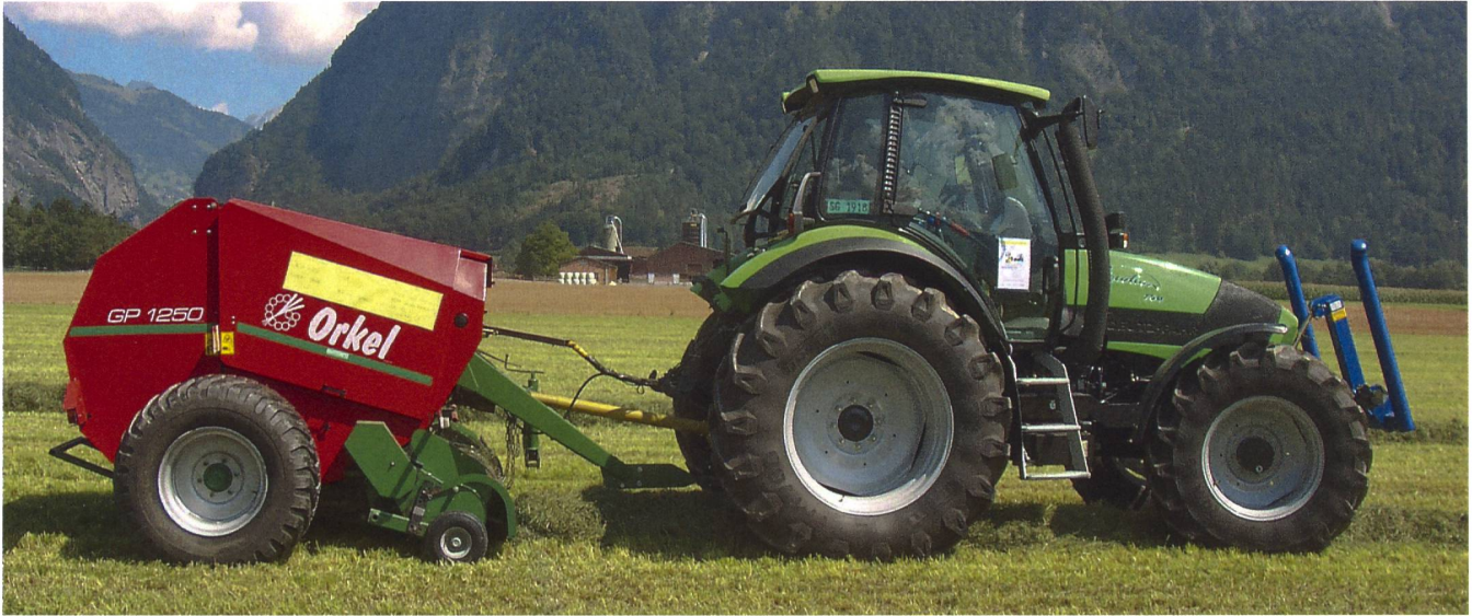
Konstantkammerpressen fordern vom Traktor mehr Antriebsleistung als variable Kammerpressen. Sie werden für die Herstellung von Silageballen bevorzugt. (Bild: Ueli Zweifel)
