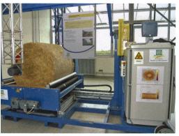
Der mobile Dichteprüfstand des DLG-Testzentrums in Gross-Umstadt (Hessen) liefert radiometrisch in einem dreidimensionalen Raster ein genaues Abbild der Dichte an jedem Messpunkt. (Bild: Ueli Zweifel)
