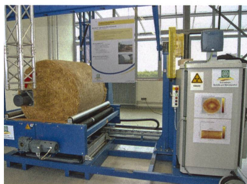
Der mobile Dichtepfprüfstand des DLG-Testzentrums in Gross-Umstadt (Hessen) liefert radiometrisch in einem dreidimensionalen Raster ein genaues Abbild der Dichte an jedem Messpunkt. (Bild: Ueli Zweifel)
