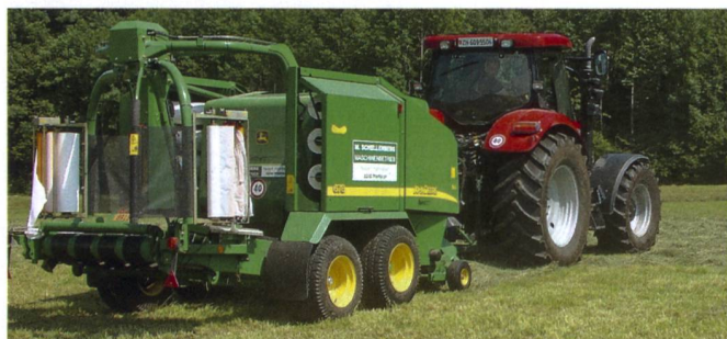
Press-Wickler-Kombinationen sind durch ihre Kompaktheit am Feldrand vergleichsweise leicht zu manövrieren, (Bild: Ueli Zweifel)
