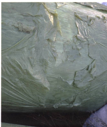
Wenn der UV-Schutz ungenügend ist oder langsam abnimmt, entstehen Auflösungserscheinungen bei der Stretchfolie.
