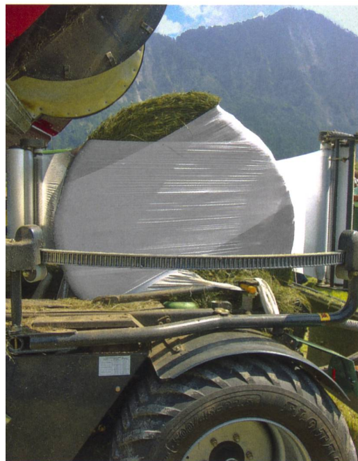
Luftdichter Abschluss durch die erstaunlichen Eigenschaften der Stretchfolie: dehnbar, reissfest, ultraviolettstabil. (Bild: Ueli Zweifel)
