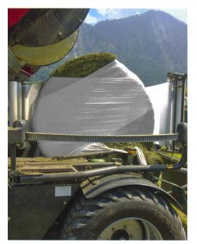
Luftdichter Abschluss durch die erstaunlichen Eigenschaften der Stretchfolie: dehnbar, reissfest, ultraviolettstabil. (Bild: Ueli Zweifel)
