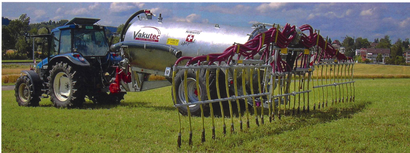
Schleppschauchverteilersysteme werden stark gefördert, weil sie einen wesentlichen Beitrag zur bedarfs- und umweltgerechten Gülleausbringung leisten. (Bild: ART)
