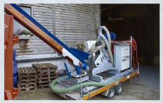
zum Beispiel die Zwischenlagerung der Dünngülle, wenn keine leeren Güllebehälter vorhanden sind. Auch muss die Durchsatzleistung des Separators hoch genug sein. Durchsatzleistungen von 10 bis 20 Kubikmeter je Stunde reichen
