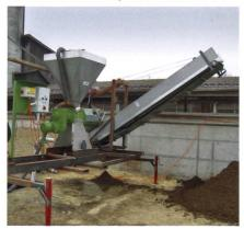
**Bauer HD-Modell S655** mit Heavy-Duty-Sieb für Einsätze, bei denen ein hoher TS-Gehalt im Feststoff gefordert wird.
