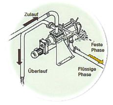
separiert werden. Schlachtbetriebe separieren Materialien wie zum Beispiel Panseninhalt. Brennereien trennen ihre Brennabfälle, und Biogasanlagen separieren vor oder nach der Fermentierung das Substrat. So verkleinern sich Abfallvolumen und Geruchsemissionen. Feststoffe lassen sich als Viehfutter oder Dünger verwendet. All diese Nutzungsarten kosten aber auch viel Geld.
