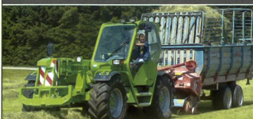
Merlo Multifarmer: Teleskopstapler und Traktor in einem. Mit Drei-Punkt- Aufhängung und mechanischer Zapfwelle
