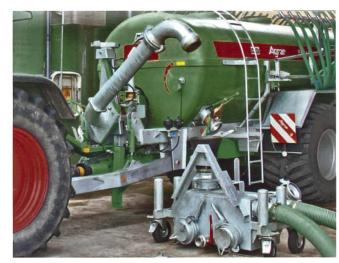
Abb. 11: Mobile Fremdkörperabscheider zur Fassbefüllung können auch schwimmende Fremdstoffe zurückhalten (Foto: GVS, Schaffhausen).
