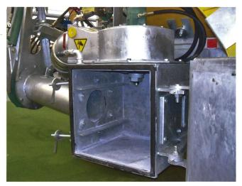
Abb. 10: Ans Fass angebaute Schneideinrichtungen mit zusätzlichem Fremdkörperabscheider vermindern Verstopfungen effektiv (Foto: Joachim Sauter, ART).
