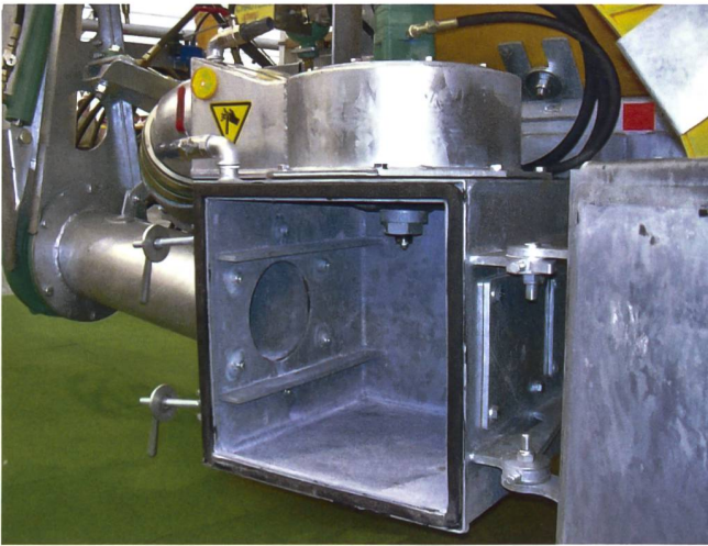
Abb. 10: Ans Fass angebaute Schneideeinrichtungen mit zusätzlichem Fremdkörperabscheider vermindern Verstopfungen effektiv (Foto: Joachim Sauter, ART).
