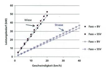
Abb. 3: Zugleistungsbedarf für das Ziehen eines Fasses mit Breitverteiler (BV), 11,1 t, und eines Fasses mit Schleppschlauchverteiler (SSV), 12,1 t, auf Wiese und Strasse (Steigung = 0%, Rollwiderstand Wiese = 0,08, Rollwiderstand Strasse = 0,028).
