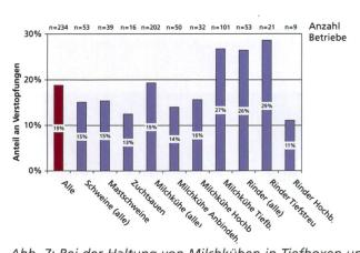
Abb. 7: Bei der Haltung von Milchkühen in Tiefboxen und Rindern treten häufiger Verstopfungen auf als bei der Schweinehaltung (Mehrfachnennungen möglich, da häufig mehre Tier- oder Haltungsarten auf einem Betrieb vorkommen, n=Anzahl an Rückmeldungen).
