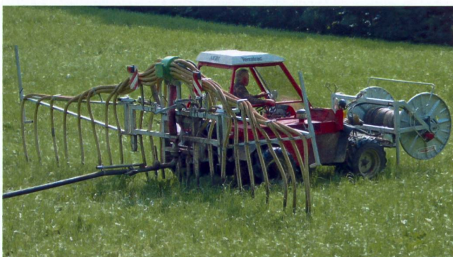
Abb. 1: Der hinterlüftete Verteilerkopf muss sich stets an höchster Stelle befinden, damit die Gülle im Schlauch abfliessen kann (Foto: Joachim Sauter, ART).
