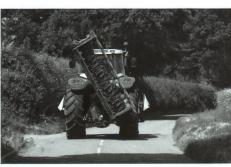
Die Vicon-Scheibenmähwerke sind mit oder ohne Aufbereiter in Heck-, Frontoder gezogener Version lieferbar. Einzigartig ist bei den 2,4- und 2,8-m-Scheibenmähern mit Aufbereiter die sehr kompakte und einfache hochgeklappte Transportstellung!
