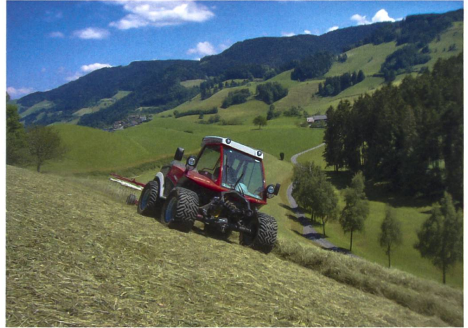
Reform G7 X mit Kreisschwader an der Heckhydraulik.
