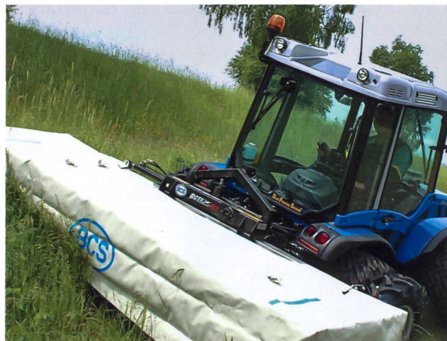
BCS-950-MT-Wendetraktor mit Scheibenmäherwerk.
