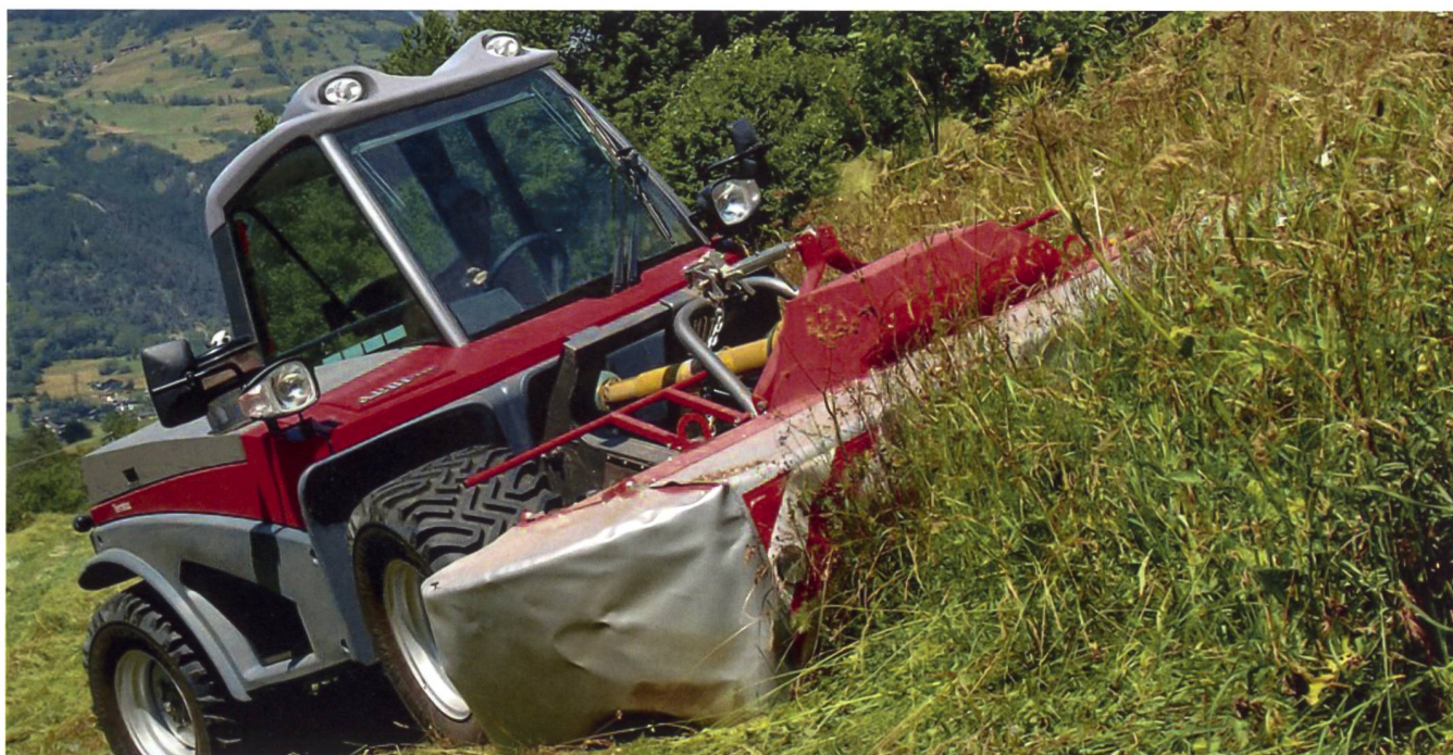
AEBI TT 275, der am besten ausgerüstete Zweiachsmäher in Bezug auf Leistung und Komfort.
