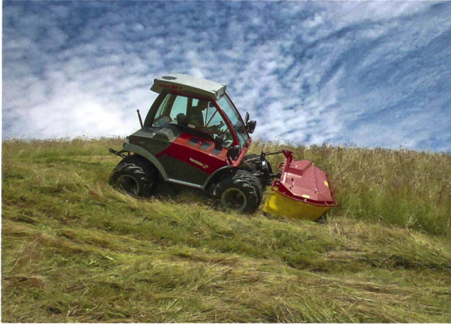
Reform G6 X, kompakt und die Räder weit aussen angebaut gewährleisten Standfestigkeit und Wendigkeit.
