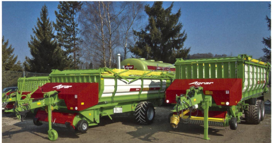
Mammut-Ladewagen als Tiefgänger und Bison-Allzweckladewagen mit Schwingenförderer als Beispiele für den modularen Aufbau.
