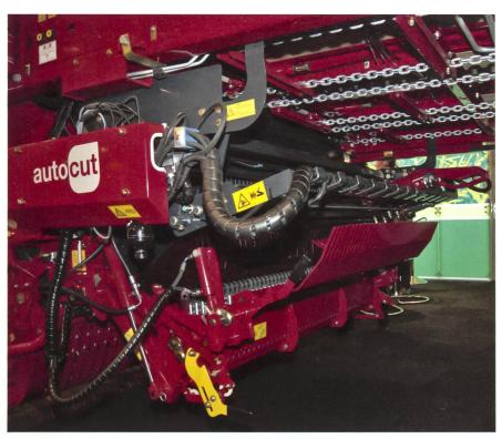
Pöttinger rüstet seine Jumbo-Ladewagen mit dem Autocut-Messerschleifsystem aus. Damit lassen sich die Messer zum Beispiel während der Leerfahrt regelmässig nachschleifen.
