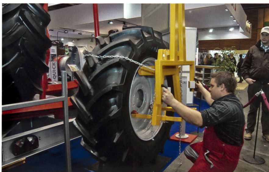
Am Stand von Schaad, Subingen: Eine Drehhilfe auf dem Twin-Carrier erleichtert die Rädermontage.
