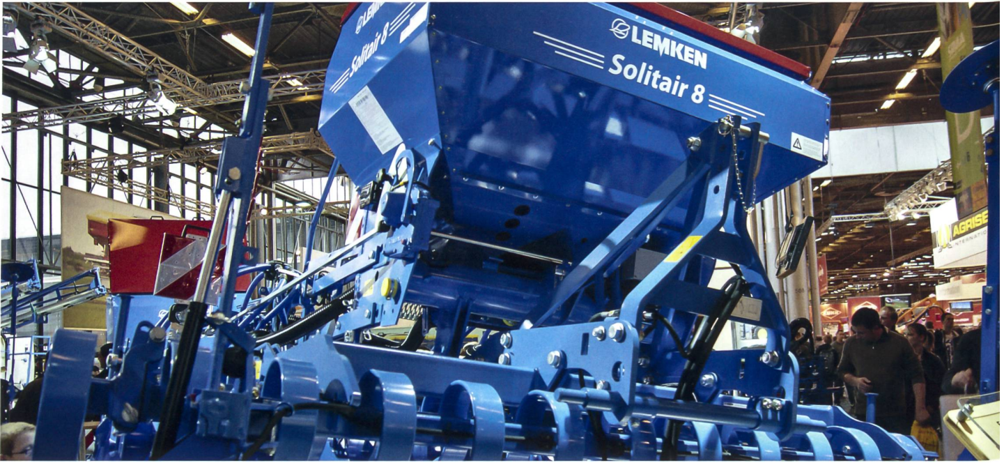
Kurzgrubber alternativ verwendbar zur Kreiselegge in Kombination mit der Solitair 8.
