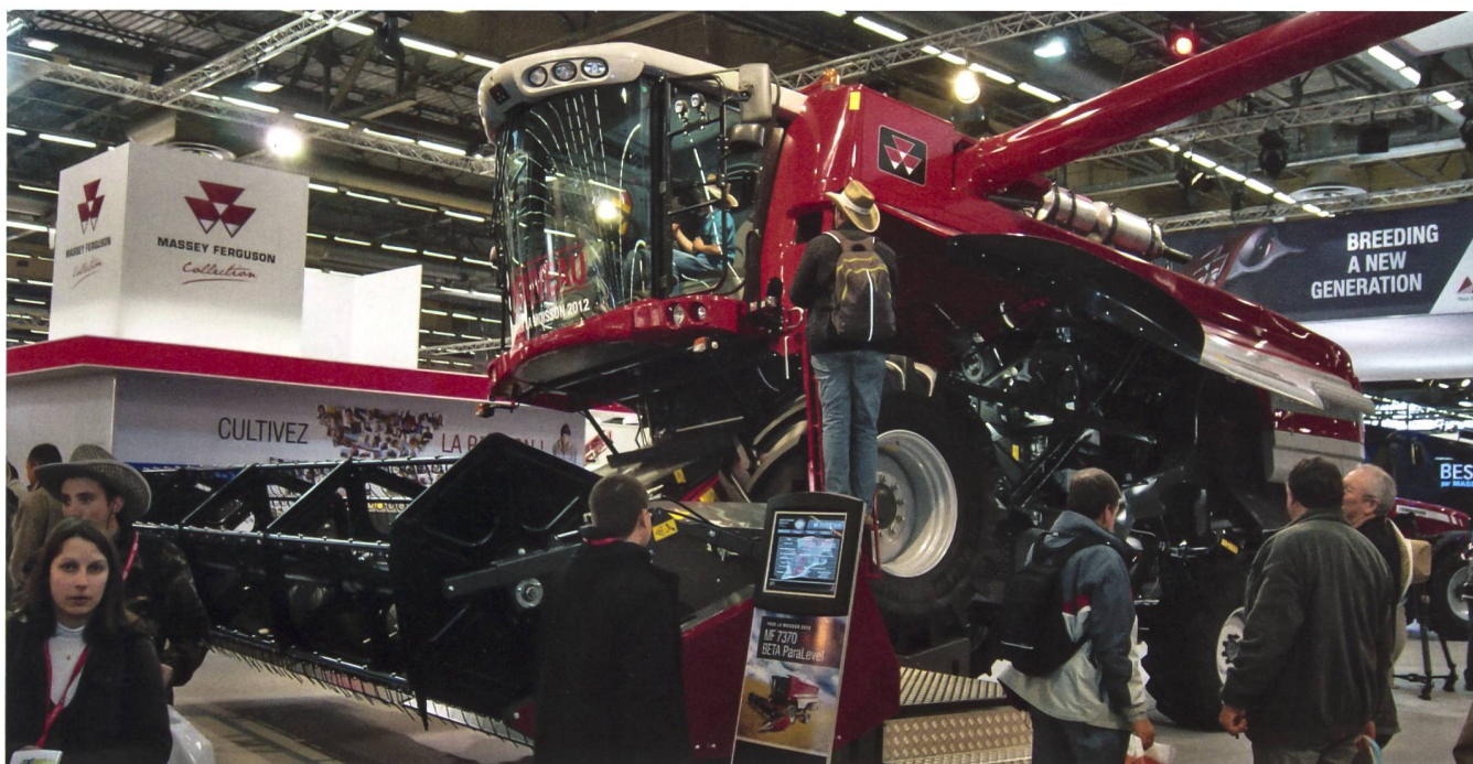
Beeindruckend in Szene gesetzt: Massey Ferguson präsentiert mit dem MF7360 und MF7370 Beta ParaLevel ein neues Mähdrescherkonzept mit automatischem Hangaussgleich (Bilder: Ueli Zweifel).
