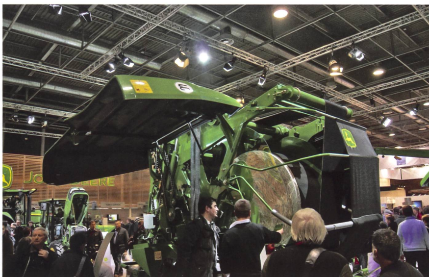
Neue John-Deere-Ballenpressen 960 (Durchmesser 60–160 cm) und 990 (60–185 cm) mit neuem Entladesysteme, das den fertigen Ballen innert weniger Sekunden freigibt. Trotz variabler Presskammer wird eine sehr hohe Pressdichte erreicht.
