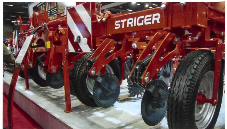
Scheibensäschar bei Sully sowohl für die Saat nach dem Pflug als auch in Pflanzenrückstände. Ein Federmechanismus kann auf Zug oder Druck gestellt werden, um die Säschar im lockeren Boden zu entlasten beziehungsweise zu belasten, damit sie etwa bei Mulchsaat in den Boden gedrückt wird.
