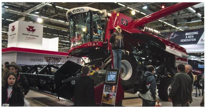
Beeindruckend in Szene gesetzt: Massey Ferguson präsentiert mit dem MF7360 und MF7370 Beta ParaLevel ein neues Mähdrescherkonzept mit automatischem Hangausgleich (Bilder: Ueli Zweifel).
