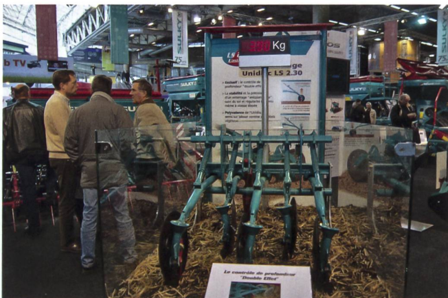
Scheibensäschar bei Sully sowohl für die Saat nach dem Pflug als auch in Pflanzenrückstände. Ein Federmechanismus kann auf Zug oder Druck gestellt werden, um die Säschar im lockeren Boden zu entlasten beziehungsweise zu belasten, damit sie etwa bei Mulchsaat in den Boden gedrückt wird.
