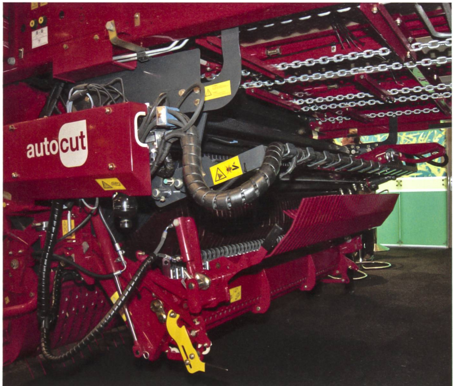
Pöttinger rüstet seine Jumbo-Ladewagen mit dem Autocut-Messerschleifsysteem aus. Damit lassen sich die Messer zum Beispiel während der Leerfahrt regelmässig nachschleifen.
