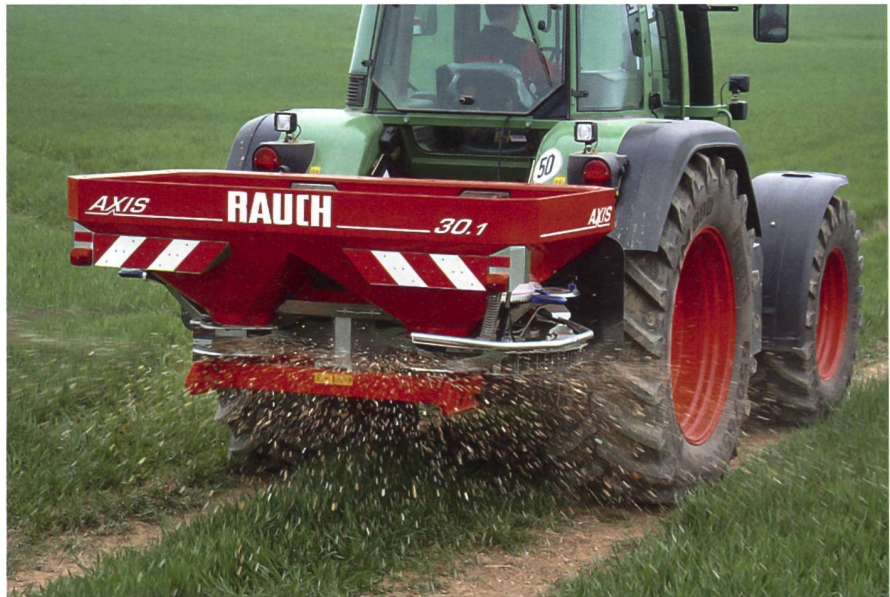
Die Verteiltechnik des Zentrifugalstreuers ist mit 50 Metern Streubreite an der physikalischen Grenze angelangt.
