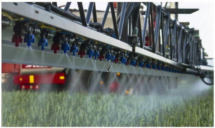
Doppelflachstrahldüsen sichern auch bei Geschwindigkeiten über 8 km/h eine beidseitige Benetzung der Pflanzen. (Werkbild Leeb)
