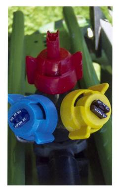
Dank Mehrfachdüsenträger stehen für unterschiedliche Anwendungen verschiedene Düsen zur Verfügung.
