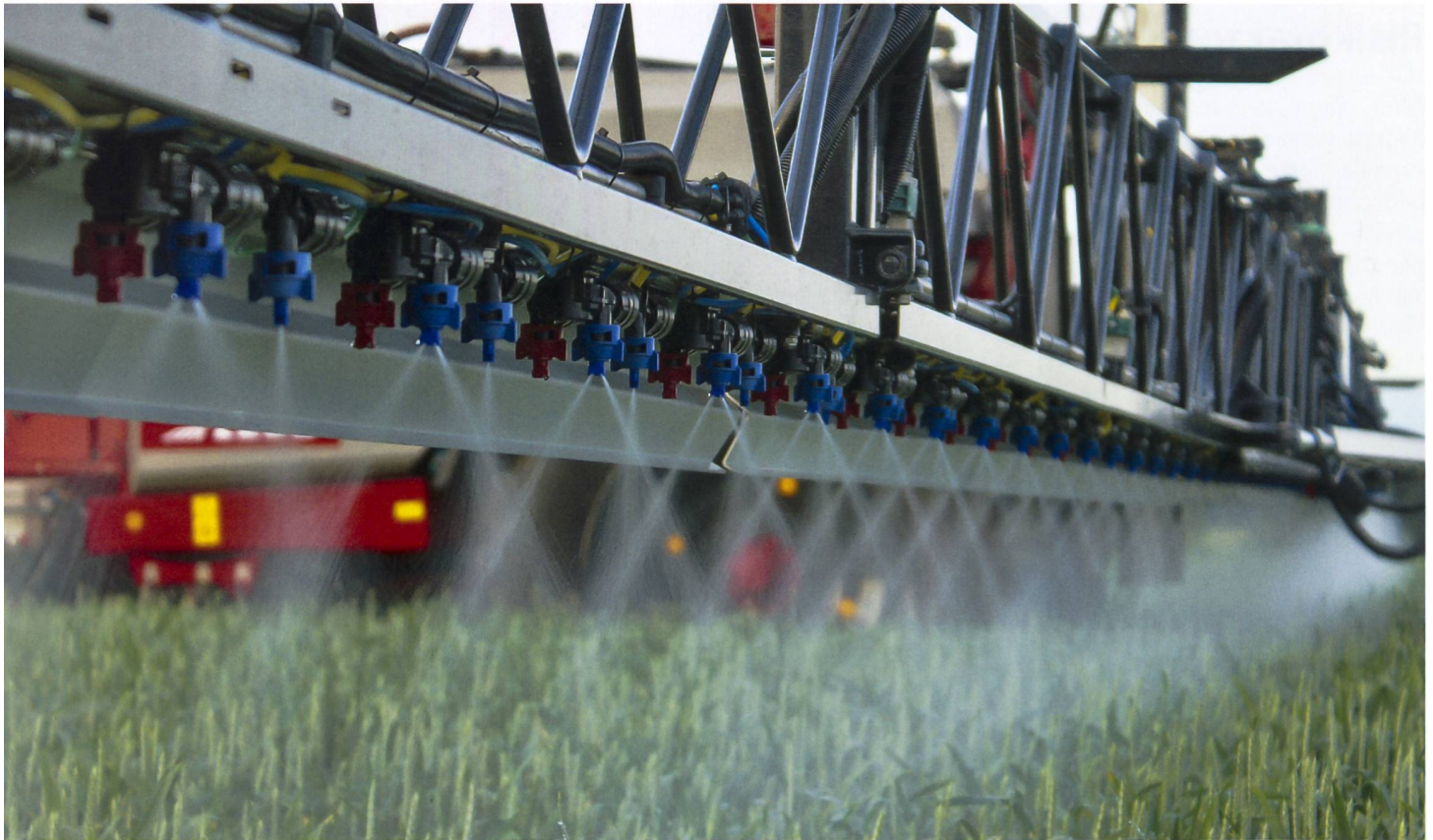
Doppelflachstrahldüsen sichern auch bei Geschwindigkeiten über 8 km/h eine beidseitige Benetzung der Pflanzen. (Werkbild Leeb)
