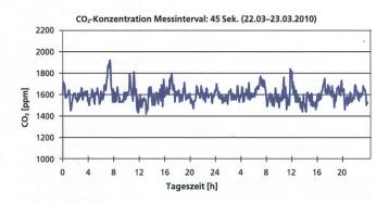
Abb. 7: Eine häufigere Anpassung der Luftrate (45-Sekunden-Intervall) führt zu besserer Angleichung der CO2-Konzentration an den Sollwert (1600 ppm).
