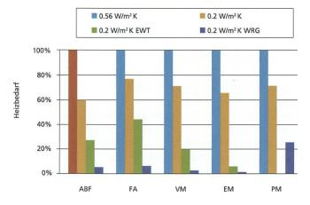
ABF=Abferkelstall, FA=Ferkelaufzuchtstall, VM=Vormaststall, EM=Endmaststall, PM=Geflügelmaststall
