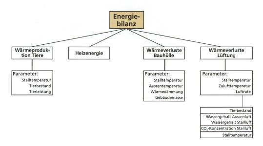
Abb. 3: Einflussparameter zur Berechnung der Energiebilanz.
