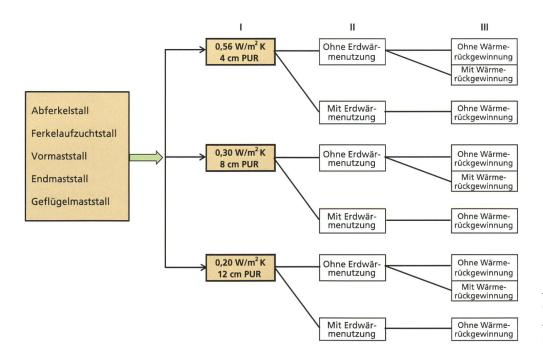
Abb. 2: Ausgeführte Modellrechnungen für schiedene Stalltypen und Energiesparmassnahmen.
