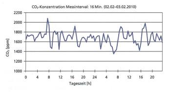
Abb. 6: Wird die Luftrate nur alle 16 Minuten geregelt, schwankt die CO2-Konzentration im Stall stark (Sollwert 1600 ppm).
