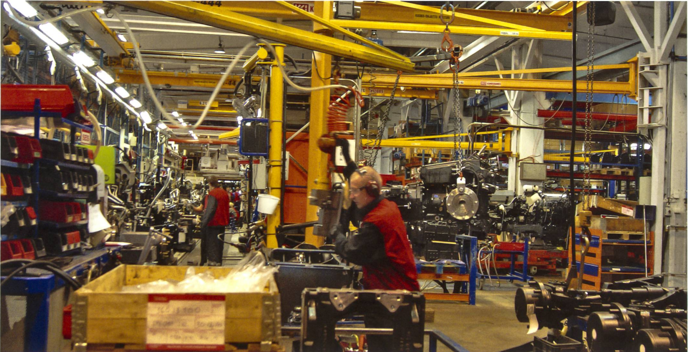
Die Valtra-Fabrik in Suolahti zählt 800 Mitarbeiterinnen und Mitarbeiter. Grosse Teile des Werks wurden mit neuester Fertigungstechnik und Mechatronic optimiert: Blick in die Getriebefabrik, wo die Versu- und Direct-Getriebe gebaut und einer minutiösen Vorprüfung unterzogen werden. (Bilder: Ueli Zweifel)
