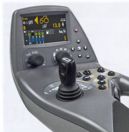
Armlehne mit Farbdisplay für Tag- oder Nachtbetrieb. (Werkfoto)
