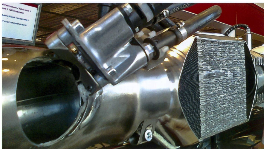
Schnittmodell: Blick auf den Abgasstrang mit Dieselpartikelfilter und SCR-Sensortechnik sowie AdBlue-Einspritzdüsen zur Stickoxidneutralisierung.
