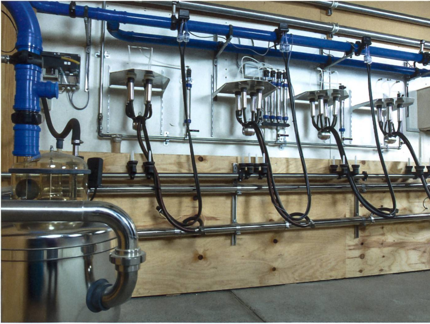
Experimentelle Melkwand mit vier Milchflusssimulatoren. (Foto: Gabriela Brändle, ART)
