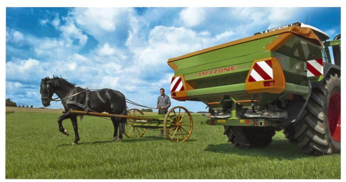
Ende der 50er-Jahre des letzten Jahrhunderts löste der Schleuderstreuer den Kastenstreuer ab. Enorme Flächenleistungen durch hohe Fahrgeschwindigkeit, grosse Arbeitsbreiten und geringer Wartungsaufwand zeichnen moderne Geräte aus. Hinzu kommt auch die exakte Verteilung bis zum Feldrand. (Werkbild Amazone)
