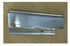
... sogar Löcher bilden. Eine exakte Düngerverteilung ist nicht mehr möglich, Schaufeln rechtzeitig auswechseln!
