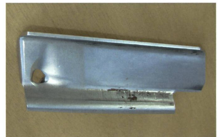
... sogar Löcher bilden. Eine exakte Düngerverteilung ist nicht mehr möglich, Schaufeln rechtzeitig auswechseln!
