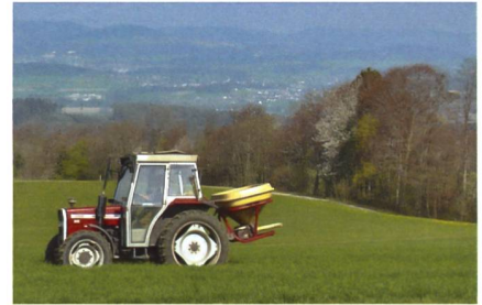
So nicht: Auch bei der Spätdüngung muss der Streuer vorschriftsgemäss angebaut werden, in diesem Falle 75 cm über der Kultur und parallel zum Boden.
