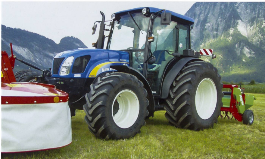
In Kombination mit dem Frontmäherwerk, bietet sich der Heckaufbereiter an.
