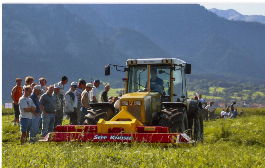
Geschobene Frontmäherwerke sind einfacher konstruiert, leichter im Gewicht und üblicherweise auch billiger in der Anschaffung.
