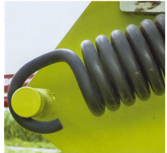
Die Balkenentlastung über Federn erfüllt zwar den Zweck weitgehend, bietet aber wenig Komfort und wird daher kaum angepasst.
