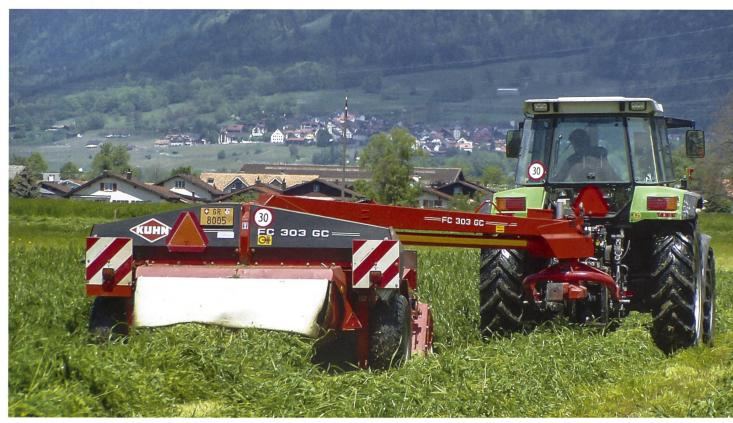
Eine korrekt eingestellte Schnitthöhe verhindert, dass Sand und Erde im Übermass ins Futter gelangt.
