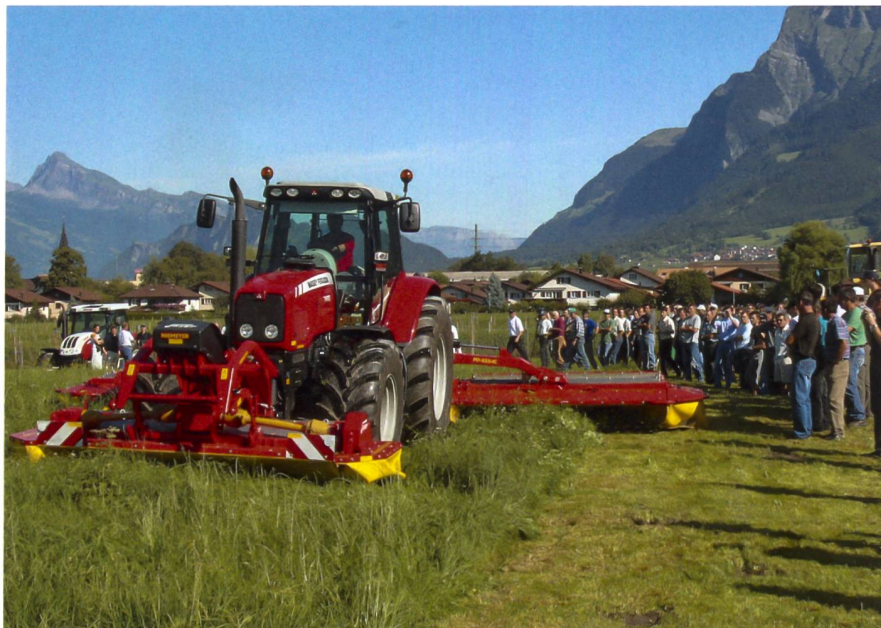
Das Frontmäherwerk in gezogener Aufhängung passt gut zu den beiden Heckmäherwerken
