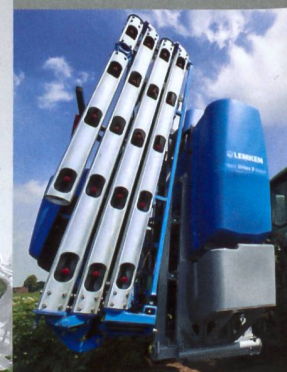
Bewährtes Aluohrgestänge, 2,35 m Transportbreite
