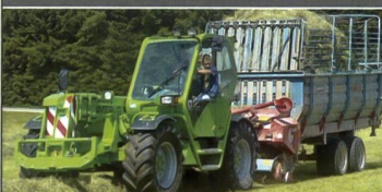
Merlo Multifarmer: Teleskopstapler und Traktor in einem. Mit Drei-Punkt-Aufhängung und mechanischer Zapfwelle
