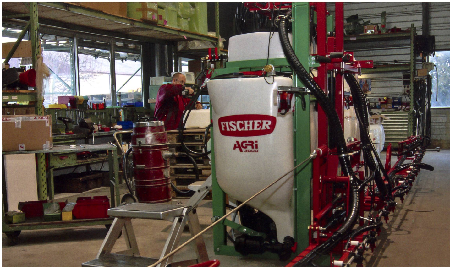
Die Fertigung konzentriert sich heute in erster Linie auf die sorgfältige Montage der zugelieferten Komponenten. Im Bild gut erkennbar ist die frei wählbare Positionierung der Düsenkörper auf den Stangenelementen am Spritzbalken (Bilder: Ueli Zweifel).
