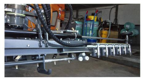
Zweites Standbein: Waschbalken für Strassenkehrmaschinen mit hydraulisch verstellbarer Seitenverlängerung sowie Ein- und Ausschaltmechanismus der involvierten Waschdüsen.
