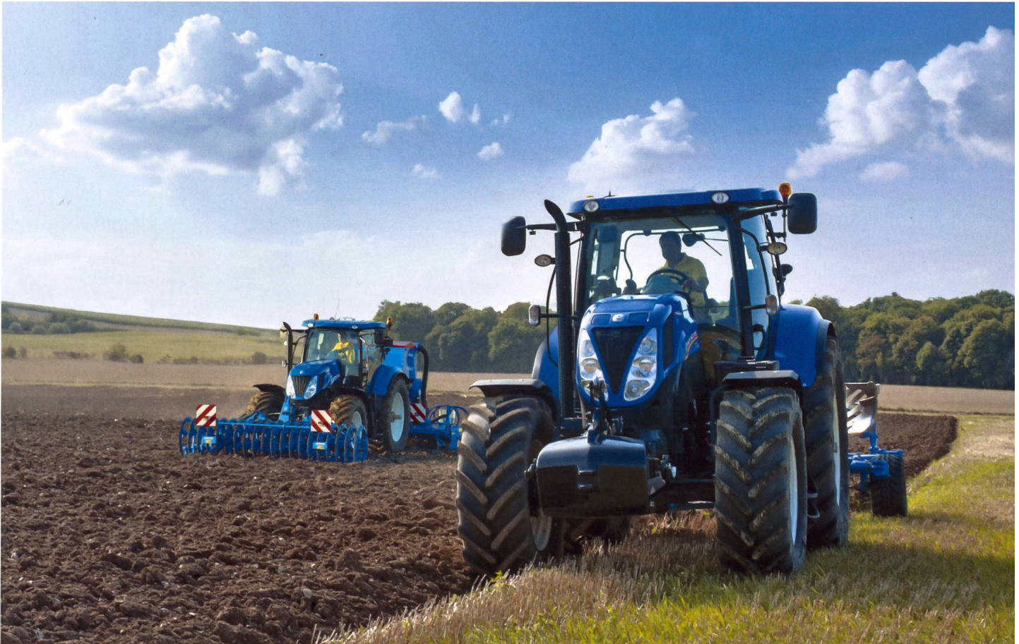
CNH bietet in den Baureihen Steyr CVT, Case CVX und New Holland AutoCommand seit 2009 eigene Stufenlosgetriebe an. Ab 2011 werden auch die Traktoren im Leistungsbereich 130 bis 165 PS damit ausgestattet.
