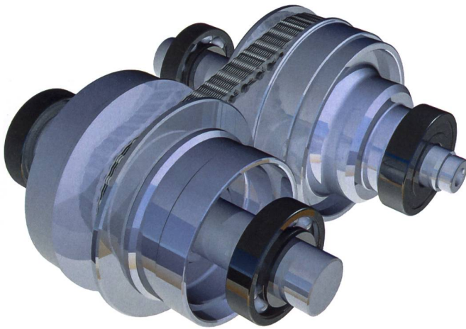
Im variablen Zweig des EasyDrive-Getriebes von New Holland wird ein Stahlketten-Variator verwendet (Baureihe Boomer).
