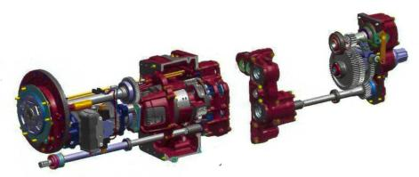
Beim neuen TTV-Getriebe von Same Deutz-Fahr erfolgt die Leistungsverzweigung über eine Stirnradstufe am Getriebeeingang, die Summierung über ein Planetengetriebe (linker Teil in der Bildmitte).
