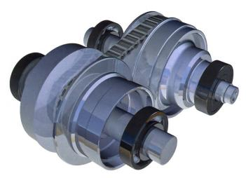
Im variablen Zweig des EasyDrive-Getriebes von New Holland wird ein Stahlketten-Variator verwendet (Baureihe Boomer).
