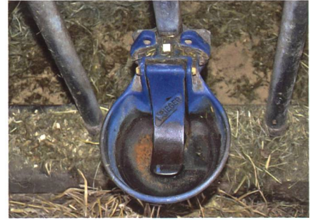
Ventile können durch Rostpartikel aus der Leitung teilweise verstopfen, was zur Folge hat, dass eine ungenügende Wassermenge nachläuft.
