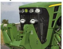
Für mehr Sicherheit und grössere Benützerfreundlichkeit wurde bei Laforge ein neues Konzept für die Steuerung der Hubwerkarme entwickelt. Das Hubwerk kann mit einem Schaltknopf von der Arbeitsposition zur eingeklinkten Position geschwenkt werden; die Rückkehr zur Arbeitsfunktion erfolgt ganz automatisch. Zusätzliche Sicherheit wurde durch den Wegfall der vorstehenden Teile an der Front erreicht.
