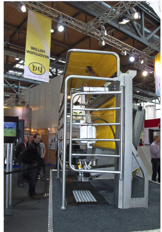
Kuhzutritt und Ausgang in gerader Linie beim neuen Astronaut-Melkstand.
