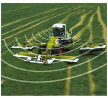
Im Rahmen seines Projekts «Wildretter» hat Claas ein Überwachungssystem mit einer Infrarotkamera zum Erfassen der Präsenz von Wildtieren entwickelt. Der Fahrer bekommt ein Warnzeichen, wenn sich Tiere im Kamerafeld befinden. Nebst der Vermeidung von Schäden an den Mähmaschinen geht es um das Risiko der Entstehung von Botulismus-Vergiftungen durch verwesendes Tiermaterial im Futter.
