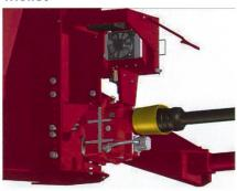
Bei Trioliet wurde der neue Getriebekasten «Powershift» mit zwei lastschaltbaren Stufen entwickelt. Damit lassen sich die Probleme grosser Belastungen beim Anlaufen für die grossen Futtermischwagen (18–30 m³) beheben. Zum Umschalten braucht der Benützer zudem die Zapfwelle des Traktors nicht abzuschalten. Der Getriebekasten lässt sich nach fünf verschiedenen Steuerungsprogrammen entsprechend dem Gewicht des geschleppten Geräts einstellen.
