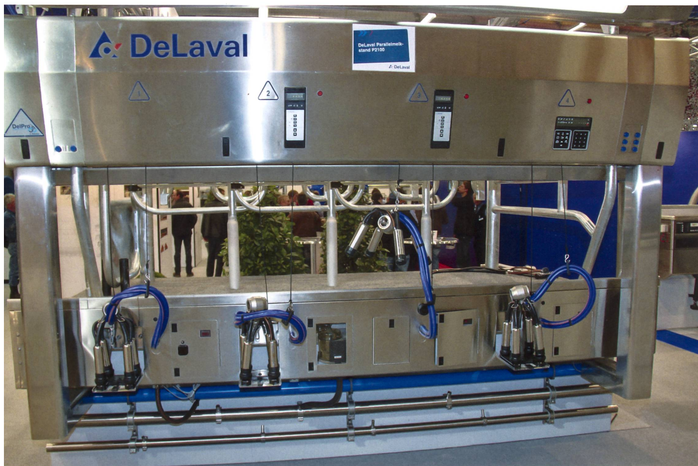
Im Melkstand haben die Hygiene und der Schutz vor Feuchtigkeit und Schmutz der empfindlichen Teile oberste Priorität. (Bilder: Gaël Monnerat)
