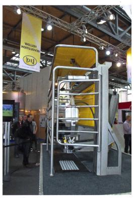
Kuhzutritt und Ausgang in gerader Linie beim neuen Astronaut-Melkstand.
