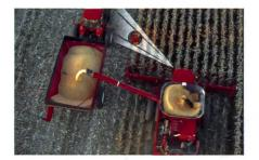
gramms «Advanced Farming System» entwickelt hat. Es geht darum, von einem Fahrzeug aus die Kontrolle über ein anderes auszuüben. Die Applikation aktiviert die Synchronisierung von zwei Fahrzeugen, zum Beispiel von einem Mähdrescher und einem Traktor, und dadurch wird die Produktivität der eingesetzten Technik umfassend erhöht. Sowohl die Geschwindigkeit wie die
