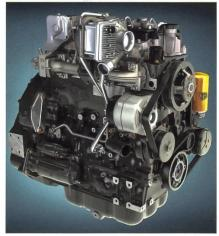
Der neue Motor «JCB Ecomax T4» von JCB SAS macht die nachträgliche Abgasbehandlung überflüssig. Dafür verantwortlich sind die besondere Form der Kolbenköpfe, die Common-Rail-Technik der zweiten Generation, ferner eine ausgeklügelte Anordnung der Einspritzdüsen sowie ein variabler Turbolader und ein optimiertes externes Abgasrückführungssystem zur Senkung des Treibstoffbedarfs.
