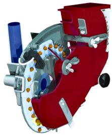
Auf einem herkömmlichen, pneumatischen Einzelkornsäaggregat ändert sich der Lochdurchmesser je nach Grösse des Saatgutkorns, und die Umfangsgeschwindigkeit beeinflusst den Kornabstand in der Reihe.
