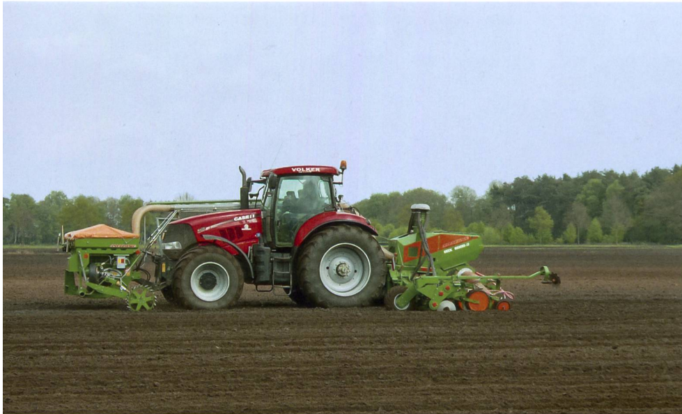
Die Nutzung eines Vorratstanks an der Traktorfront vergrössert den Aktionsradius beim Säen und bringt eine bessere Lastverteilung auf dem Traktor.
