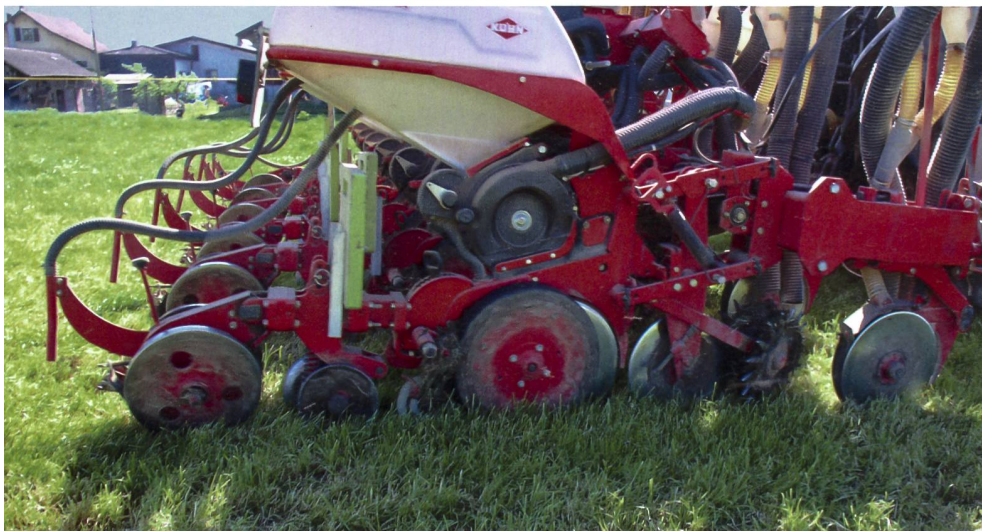
Düngerablage, Furchenräumung und -öffnung, Saatgutablage, Furchen- und Bodenschluss, Granulatapplikation und Bienenschutz. Viele Funktionen müssen bei der Direktsätechnik erfüllt sein.
