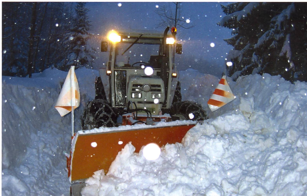
Die Schneeketten werden beim Schneeräumen stark beansprucht. (Bild: Stefan Suter)
