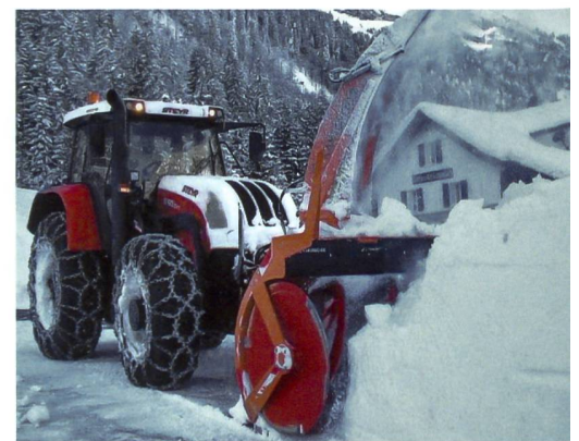
Die Schneefräse bewältigt zwar grosse Schneemassen. Doch ist deren Leistungsbedarf und Treibstoffverbrauch bei erhöhtem Zeitaufwand für die Schneeräumung wesentlich grösser als mit dem Schneeschild. (Bild: Stefan Suter)
