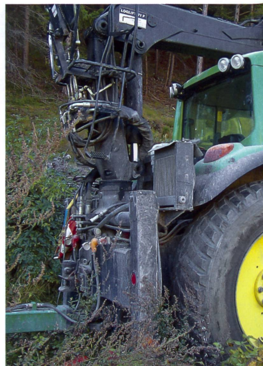
Ein fest aufgebauter Holzladekran belastet die Traktorhinterachse und macht den Traktor zum Spezialfahrzeug (Bild Hunger).
