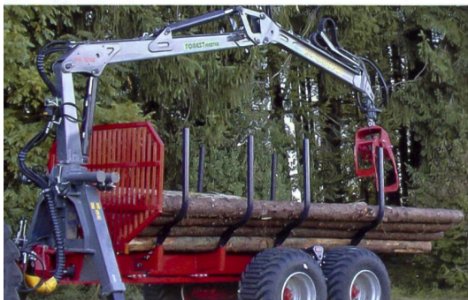
Rückewagen mit standsicherem Kranaufbau und Hilfsantrieb über die Stollenbereifung. Bild: Baldinger GmbH, Lengnau AG
