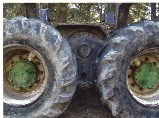
Reifen werden im Wald stark strapaziert und müssen entsprechend robust sein. Man beachte auch den massiven Ventilschutz.
