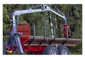
Rückewagen mit standsicherem Kranaufbau und Hilfsantrieb über die Stollenbereifung. Bild: Baldinger GmbH, Lengnau AG)
