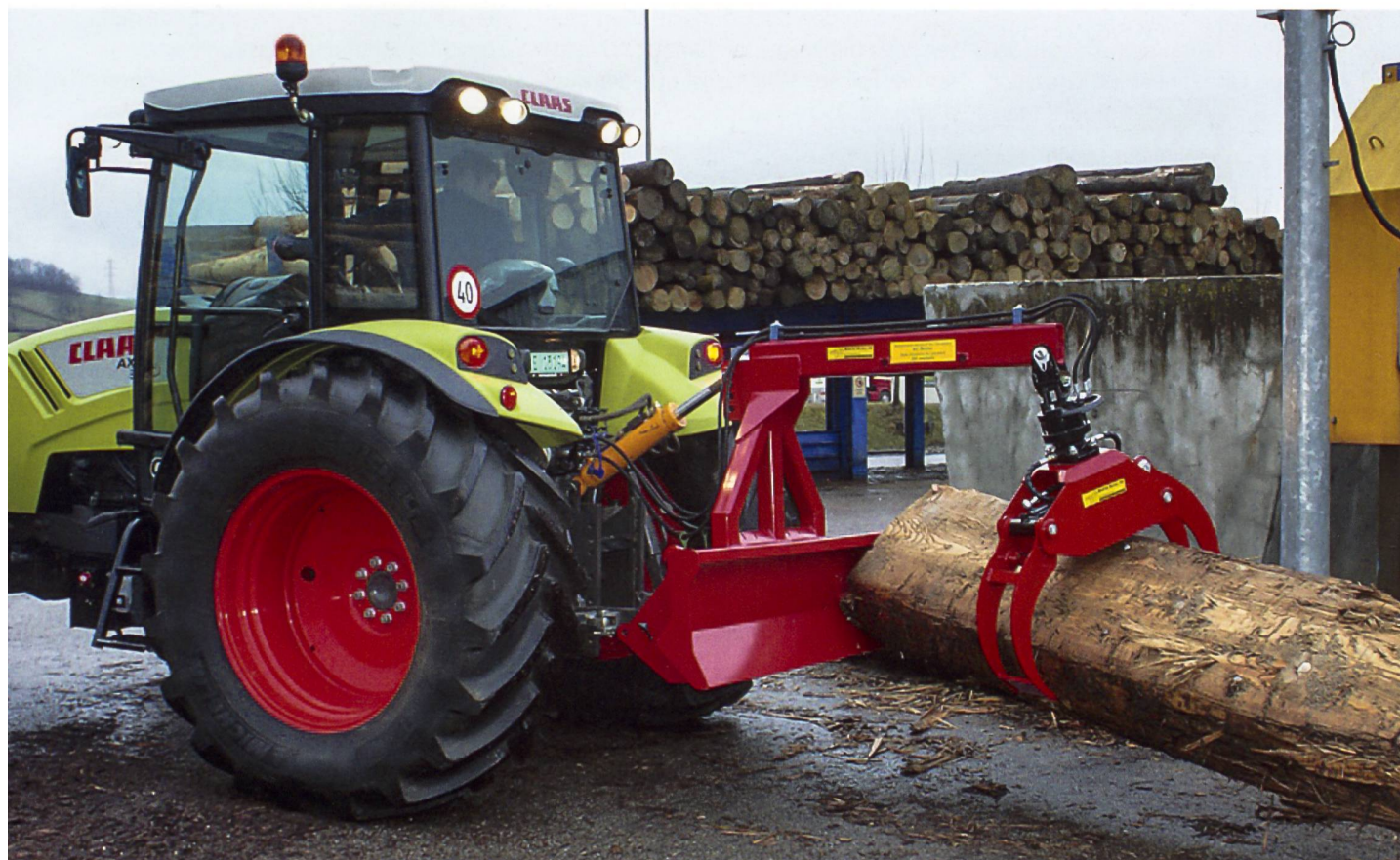
Rückezange: Schwache bis mittlere Holzstärken lassen sich mit hoher Leistungsfähigkeit verschieben, falls es die Topografie zulässt (Bild: Ruckli AG, Buttisholz LU).
