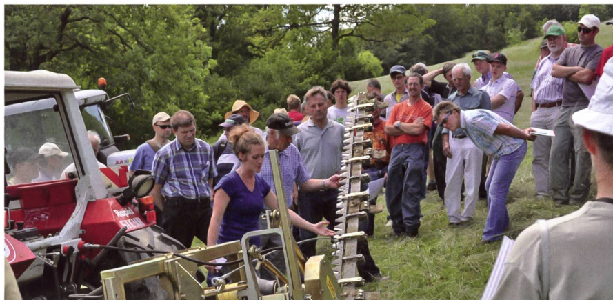
Astrid Böll von der Fachstelle Landtechnik Liebegg stellt die Maschinen vor: Doppelmesserbalken mit 2,3 m Arbeitsbreite und nur 250 kg Gewicht am Traktor Steyr mit 42 PS. Doppelmesserbalken sind sehr leicht, weitgehend verstopfungsfrei, brauchen aber häufig Pflege (Messer schleifen).
