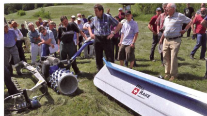
Der Brielmaier-Motormäher verfügt über einen Doppelmesserbalken mit max. 3,5 m Arbeitsbreite. Daneben «Hill Rake» von Erni Landmaschinen in Menzberg zum Talwärts-Schieben von Heuschwaden. (Bilder Paul Müri)
