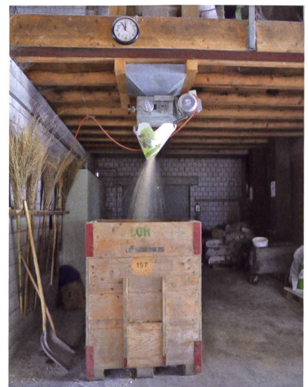
Mahlen: Mit einer Rollenmühle wird der Feuchtmals vor der Verfütterung grob gemahlen.
