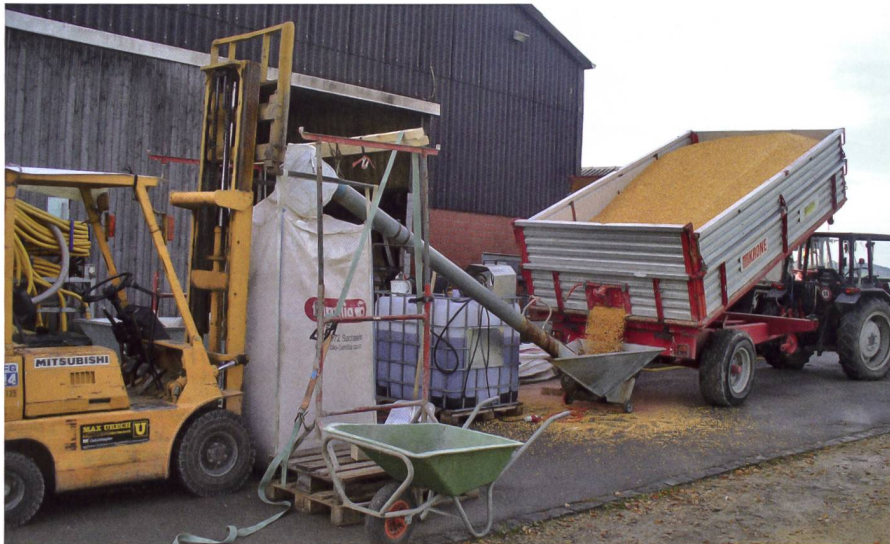
Ansäuern: Im Schneckenelevator wird Säure auf die Maiskörner gespritzt zur Unterdrückung von Schimmelpilzen.
