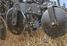
Abb. 1: Streifenlockerer Horsch Focus (links), Yetter (rechts).
