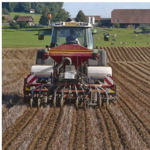
Pro gefräster Streifen werden zwei Reihen Raps im Abstand von 25 cm gesät.
