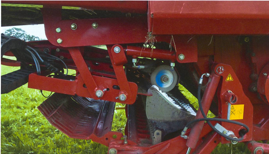
Die vollautomatische Schleifeinrichtung schleift die Klingen im eingebauten Zustand. (Bildquelle: Pöttinger)
