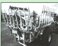
Schleppschlauch-Verteiler mit Fass
