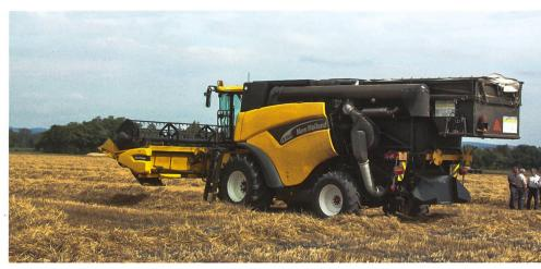
In der Transportstellung respektiert der umgebaute Mähdrescher die gemäss Bau- und Ausrüstungsverordnung VTS erlaubten Abmessungen in der Höhe und Breite.
