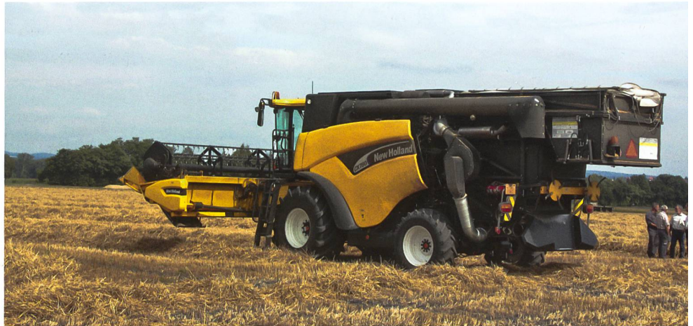
In der Transportstellung respektiert der umgebaute Mähdrescher die gemäss Bau- und Ausrüstungsverordnung VTS erlaubten Abmessungen in der Höhe und Breite.
