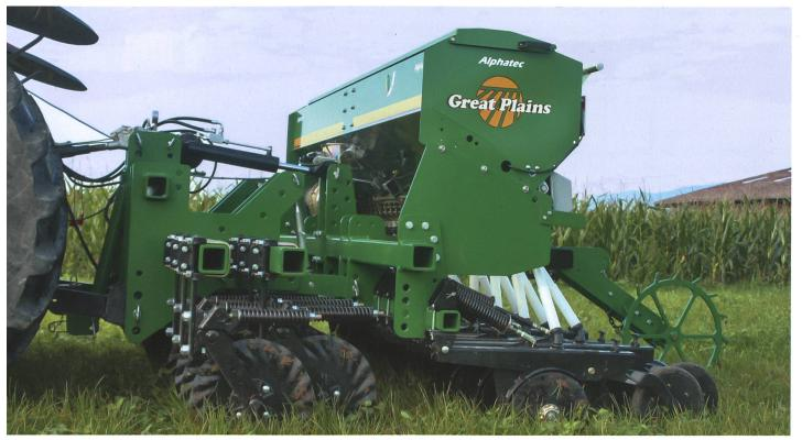
Direktsäkombination, montiert auf der von Alpahtec konstruierten Tragkonstruktion. (Bilder: zVg)
