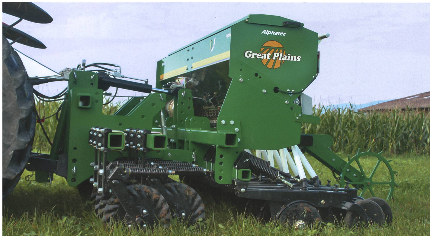
Direktsäkombination, montiert auf der von Alphatec konstruierten Tragkonstruktion. (Bilder: zVg)
