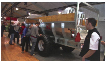
Typische Technik für den Schweizer Markt: Weiterentwicklung des Hangmissetzers mit Seitenausbringung von Gafner. Die Ladekapazität beträgt 12 m 3 , die Wurfweite bis 25 m.
