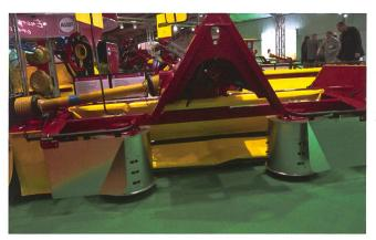
Fella entwickelte ein Frontscheibenmähwerk mit Querfördertrommeln für die mittige Schwadablage.
