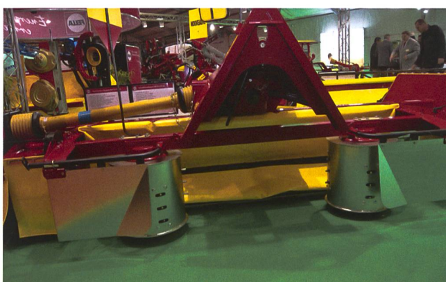
Fella entwickelte ein Frontscheibenmäherwerk mit Querförderertrommeln für die mittige Schwadablage.
