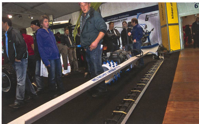
Brielmaier-Motormäher: Tausendsassa am Hang nunmehr mit einem 6-Meter-Schneidwerk
