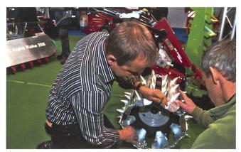
Die Motormäher werden immer hangtauglicher: zum Beispiel dank Sternbänderungen, die bei Köppel über die Räder gespannt werden.
