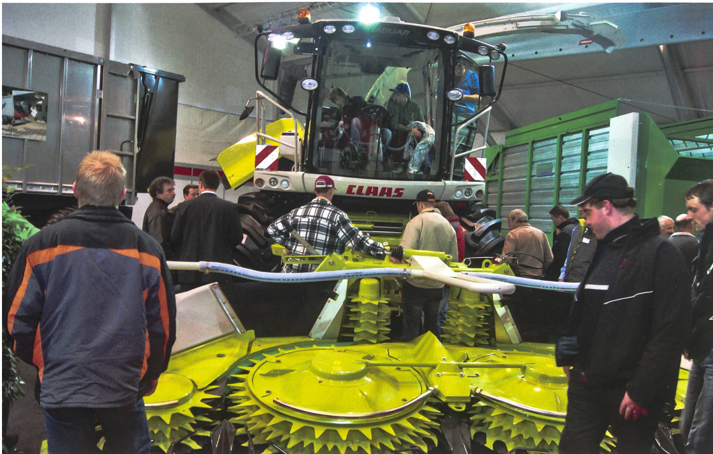
Technik auf Topniveau im provisorischen Ausstellungszelt: aktive Vorpressung durch die Einzugswalzen hinter dem neuen Maisvorsatz Orbis 450 von Claas. (Bilder: Ueli Zweifel)
