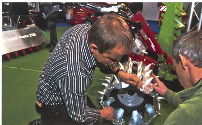
Die Motormäher werden immer hangtauglicher: zum Beispiel dank Sternbänderungen, die bei Köppel über die Räder gespannt werden.
