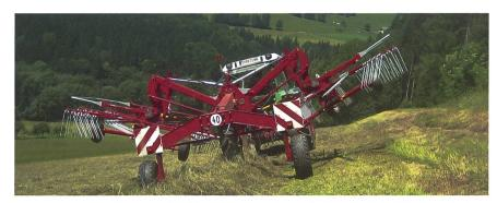
Dank eines breiten Fahrwerks bleibt auch an Hanglagen die Standfestigkeit bei ausgehobenen Kreiseln erhalten.
