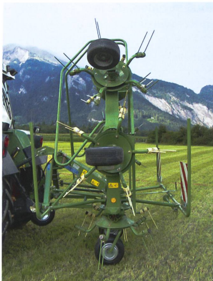
Der Verwendungszweck für Dürrfutter oder Silage bestimmt den Kreiseldurchmesser.
