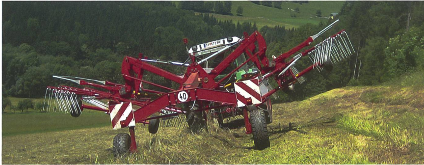
Dank eines breiten Fahrwerks bleibt auch an Hanglagen die Standfestigkeit bei ausgehobenen Kreiseln erhalten.
