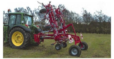
Grosse Kreiselheuer im 3-Punktanbau entlasten die Traktorenvorderachse massiv. Mit der schwenkbaren Achse wird das Problem weitgehend entschärft.
