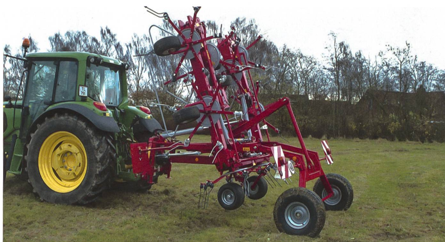
Grosse Kreiselheuer im 3-Punktanbau entlasten die Traktorenvorderachse massiv. Mit der schwenkbaren Achse wird das Problem weitgehend entschärft.
