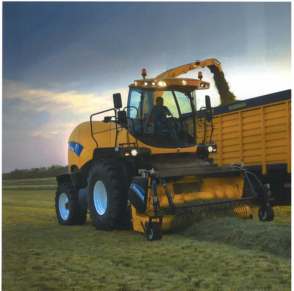
Nebst dem Touch-Screen-Monitor «Intelliview III» und der «IntelliFill»-Turmsteuerung können die FR-Häcksler neu auch mit einem Ertrags- und Feuchtigkeitsmesssystem ausgerüstet werden.
