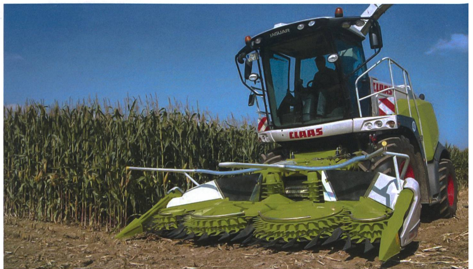
Neuer 6-reihiger Maisvorsatz Orbis 450 von Claas zur Saison 2011. Die beiden grossen Trommeln in der Mitte drehen nach aussen.
