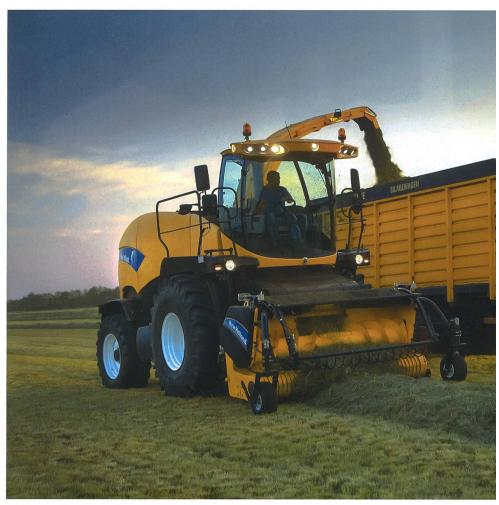
Nebst dem Touch-Screen-Monitor «Intelliview III und der «IntellFill»-Turmsteuerung können die FR-Häcksler neu auch mit einem Ertrags- und Feuchtigkeitsmesssystem ausgerüstet werden.
