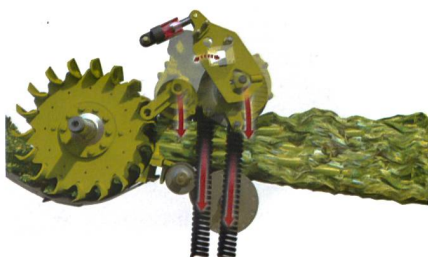
Aktive Vorpressung: Ein Hydraulikzylinder verhindert das Hochschnellen der Vorpresswalzen.
