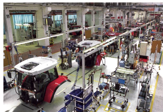
In der Kabinen-Montagehalle erhalten die angelieferten Kabinenrahmen ihre individuelle Ausstattung. Für jede Kabine werden genau die benötigten Komponenten bereitgestellt. (Firmenbild)
