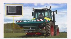
Bovey SA zeigt die neuen Düngerstreuer Sulky DPX28, Vision WPB. Über die Konsole kann die Ausstreumenge vom Traktor aus automatisch reguliert werden. Diese wird bestimmt durch die Gewichtsmessung des Düngervorrats über einen robusten Messsensor, eingebaut im Chassis
