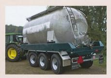
Die Walter Marolf AG stellt als innovative Entwicklung ein Tridem-Wechselchassis mit elektronischer Zwangslenkung vor. Das Fahrgestell hat ein Garantiegesamtgewicht von 33 t bei 40 km/h. Es ist ausgerüstet für die Aufnahme von normierten ISO-Containern oder Brücken von 20 Fuss (ergibt Brückenlängen bis ca. 8 m). Das Wechseln der Brücken wird hier mittels der hydraulisch höhenverstellbaren Deichsel gemacht. Andere Wechselmöglichkeiten sind Luftfederung oder ein spezielles Hydraulikhebesystem.
