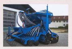
Die BMP Michel Baudet SA zeigt die neue Sämaschine C-drill von ECK-Landmaschinenbau. Neu ist die zentrale Verstellmöglichkeit der Sätiefe der CR-Scheibenschare. Vorteile bieten sich zudem durch die schnelle Kupplungsmöglichkeit Easyfit und eine Saatgutdosierung von unter 0,5 kg/ha und eine kompakte Bauweise.
