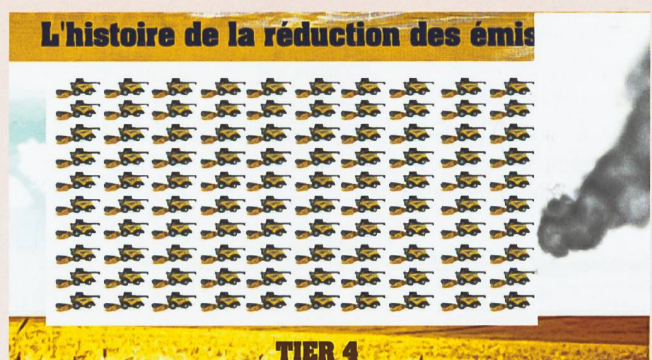
Christian Penet: «Vier für sich sprechende Bilder zur Abgasverminderung auf dem Weg von Tier 1 zu Tier 4.» 100 Fahrzeuge mit Tier 4 Motoren stossen die gleiche Menge Stickoxide und Russpartikel aus wie ein gleichwertiges Fahrzeug der Abgasstufe Tier 1.
