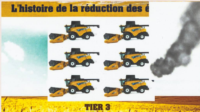
Christian Penet: «Vier für sich sprechende Bilder zur Abgasverminderung auf dem Weg von Tier 1 zu Tier 4.» 100 Fahrzeuge mit Tier 4 Motoren stossen die gleiche Menge Stickoxide und Russpartikel aus wie ein gleichwertiges Fahrzeug der Abgasstufe Tier 1.
