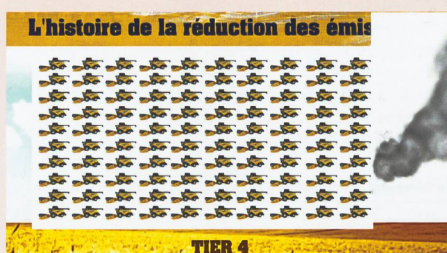
Christian Penet: «Vier für sich sprechende Bilder zur Abgasverminderung auf dem Weg von Tier 1 zu Tier 4.» 100 Fahrzeuge mit Tier 4 Motoren stossen die gleiche Menge Stickoxide und Russpartikel aus wie ein gleichwertiges Fahrzeug der Abgasstufe Tier 1.
