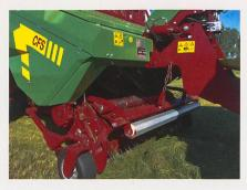
Neu bietet Strautmann einen Rotorladewagen ausgerüstet mit Spiralrotor und einer Beschleunigerwalze mit Breitzieheffekt für bessere Ausladung und Schonung der Getriebe. Der Pick-up ist ungesteuert mit spiralförmig angeordneten Zinken. Im Vergleich zu herkömmlicher Technik benötigt er einen 10% geringeren Leistungsbedarf. Erhältlich sind Modelle von 32–80 m³.
