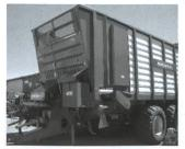
Zum störungsfreien Anhäckseln ist das Oberteil (600 mm) hydraulisch klappbar. Eine eigene Bordhydraulik sorgt für eine optimale Ölversorgung (130 l/Min.), damit die hohe Leistung immer gewährleistet ist. Das massive 80 cm breite Querförderband mit hydraulischem Antrieb ist bestens zur beidseitigen Vorneentladung geeignet, sei es für Hochsilo oder Rundballen.
