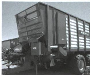
Zum störungsfreien Anhängeln ist das Oberteil (600 mm) hydraulisch klappbar. Eine eigene Bordhydraulik sorgt für eine optimale Översorgung (130 l/Min.), damit die hohe Leistung immer gewährleistet ist. Das massive 80 cm breite Querförderband mit hydraulischem Antrieb ist bestens zur
