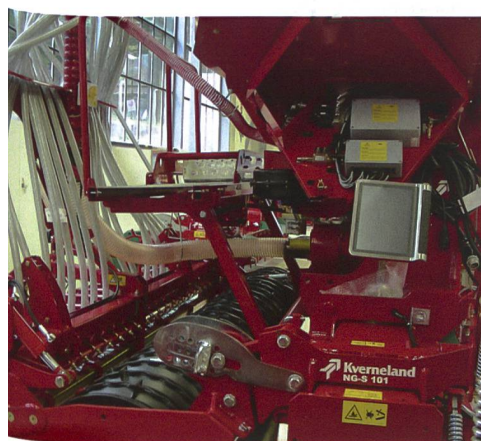
Sätkombination mit ISOBUS-Ausrüstung: Der Jobrechner befindet sich unter dem Saatgutbehälter. Das bedienerfreundliche IsoMatch Tellus Terminal von Kverneland ermöglicht mit der zweiseitigen Darstellung neben den Sämaschinen-daten gleichzeitig auch die perfekte Anzeige eines Kamerabildes oder von Traktordaten. Rückseitig sind alle Schnittstellen angebracht. (Bilder: Kverneland/F. Marti)
