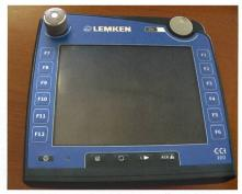
ISOBUS-Terminal CCI 200 von Lemken: Oben links sitzt der Schnellstopp-Sicherheitsschalter. Auf der Rückseite befinden sich diverse Schnittstellen wie WLAN, Ethernet, USB, Kameraanschluss, 2. CAN-BUS-Schnittstelle. CCI steht für «Competence Center ISOBUS e.V.» In diesem Verein haben sich folgende sechs Firmen zwecks Förderung des ISOBUS-Systems zusammengeschlossen: Amazone, Grimme, Krone, Kuhn, Lemken und Rauch.
