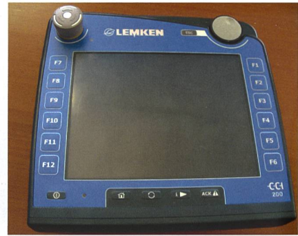
ISOBUS-Terminal CCI 200 von Lemken: Oben links sitzt der Schnellstopp-Sicherheitsschalter. Auf der Rückseite befinden sich diverse Schnittstellen wie WLAN, Ethernet, USB, Kameraanschluss, 2. CAN-BUS-Schnittstelle. CCI steht für «Competence Center ISOBUS e.V.» In diesem Verein haben sich folgende sechs Firmen zwecks Förderung des ISOBUS-Systems zusammengeschlossen: Amazone, Grimme, Krone, Kuhn, Lemken und Rauch.
