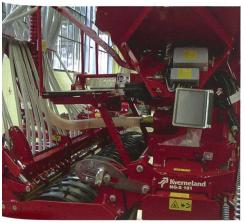
Säkombination mit ISOBUS-Ausrüstung: Der Jobrechner befindet sich unter dem Saatgutbehälter. Das bedienerfreundliche IsoMatch Tellus Terminal von Kverneland ermöglicht mit der zweiteiligen Darstellung neben den Sämaschinendaten gleichzeitig auch die perfekte Anzeige eines Kamerabildes oder von Traktordaten. Rückseitig sind alle Schnittstellen angebracht. (Bilder: Kverneland/F. Marti)
