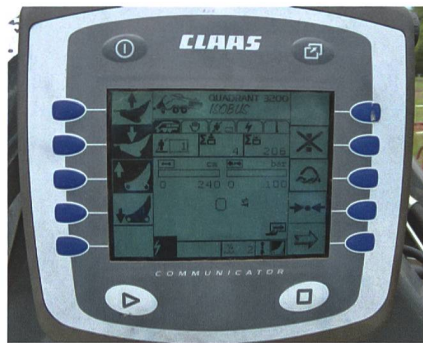
Das ISOBUS-Terminal an einer Claas-Quadrant-3200-Grossballenpresse erlaubt u.a. die Einstellung des Pressdruckes, der Ballenlänge, die Bedienung der Messer, der Schneidmulde, die Einstellung der Vorkammer. Daneben können Gutfeuchte und Drehmomentwerte abgelesen werden.
