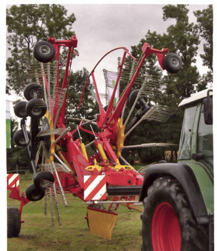
Der neue Top 852 C zeichnet sich durch das neue Chassis mit sechs Rädern und die neue Kinematik beim Anheben der Kreisel aus.
