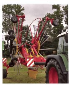
Der neue Top 852 C zeichnet sich durch das neue Chassis mit sechs Rädern und die neue Kinematik beim Anheben der Kreisel aus.
