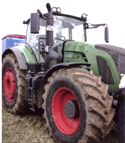
Laut Fendt leistungsstärkster Standardschlepper am Markt Vario 939. Zulässiges Gesamtgewicht 18 Tonnen mit 6-Zylinder-Deutz-Motor mit 7,8 Liter Hubraum (grössere Bohrung und grösserer Hub) und Common-Rail-Hochdruckeinspritzung (2000 bar. Gut erkennbar auch der SCR-Katalysator im Auspuffstrang)
