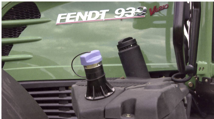
Laut Fendt leistungsstärkster Standardschlepper am Markt Vario 939. Zulässiges Gesamtgewicht 18 Tonnen mit 6-Zylinder-Deutz-Motor mit 7,8 Liter Hubraum (grössere Bohrung und grösserer Hub) und Common-Rail-Hochdruckeinspritzung (2000 bar. Gut erkennbar auch der SCR-Katalysator im Auspuffstrang)
