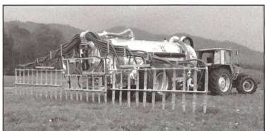
Fassverteiler passt an jedes Vakuum- oder Pumpfass.
