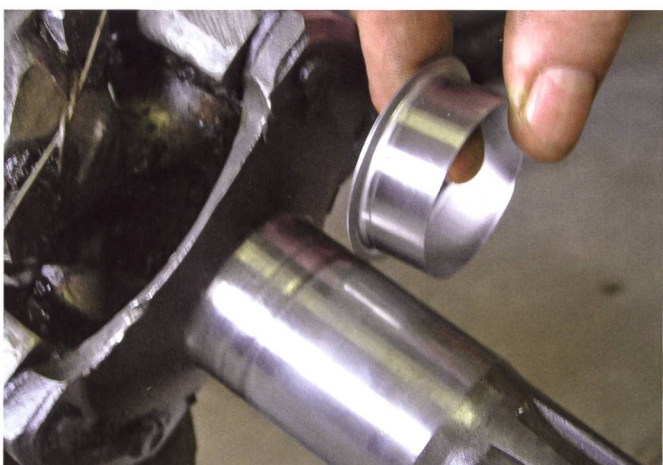
Die Wellenschutzhülse wird mit ihrem Bund voran auf die Welle gesetzt und mit einem passenden Rohr über die beschädigte Stelle geschoben.
