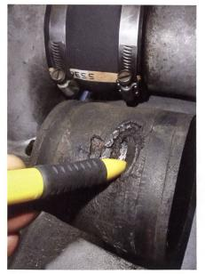
Über diesen durchgescheuerten Verbindungsschlauch ist lange Zeit staubhaltige Luft unbemerkt in den Motor gelangt. (Bilder: Hansueli Schmid)
