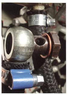
Die Hohlschraube dieser Kraftstoffleitung ist beim Anziehen gestreckt worden, das zeigt die ovale Durchgangsbohrung.
