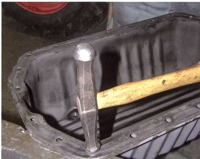
Die aufgebogenen Ränder dieser Ölwanne aus Blech werden im Bereich der Schraubenlöcher gerichtet.
