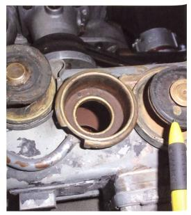
Die Dichtungen dieser Kühlerverschlussdeckel sind aufgeweicht und verzogen (links) beziehungsweise spröde und gebrochen (rechts).
