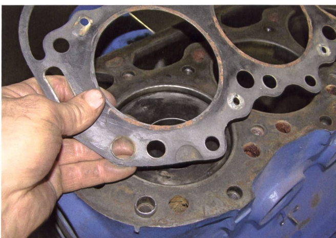
Um Zylinderkopfdichtungen selber ersetzen zu können, müssen die Daten wie Anzugswert und Reihenfolge der Schrauben bekannt sein.
