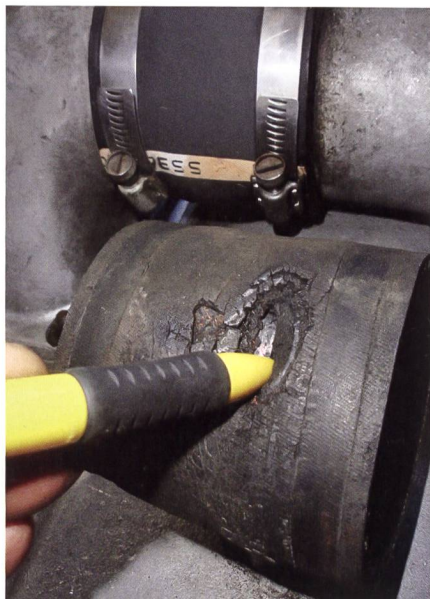
Über diesen durchgescheuerten Verbindungsschlauch ist lange Zeit staubhaltige Luft unbemerkt in den Motor gelangt. (Bilder: Hansueli Schmid)
