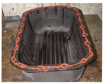
Vor dem Zusammenfügen der Teile muss die Dichtungsmasse ca.10 Minuten ablüften können, damit sie besser in der Dichtungsfuge haften bleibt.
