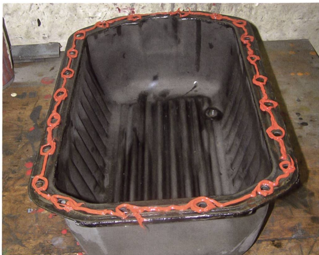
Vor dem Zusammenfügen der Teile muss die Dichtungsmasse ca.10 Minuten abtrocknen können, damit sie besser in der Dichtungs-fuge haften bleibt.
