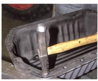
Die aufgebogenen Ränder dieser Ölwanne aus Blech werden im Bereich der Schraubenlöcher gerichtet.
